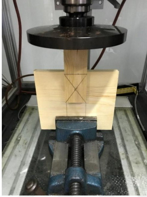
Şekil 7. Tek zımbalı sarıçam birleştirme yerine ait statik makaslama testi
