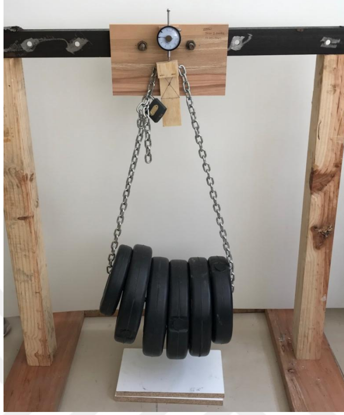
Şekil 8. Sünme testinin gerçekleştirildiği düzenek
