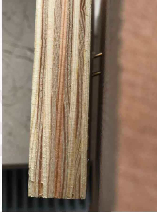
Şekil 15. Sünme testi sonucu zımba ayrılma modu
