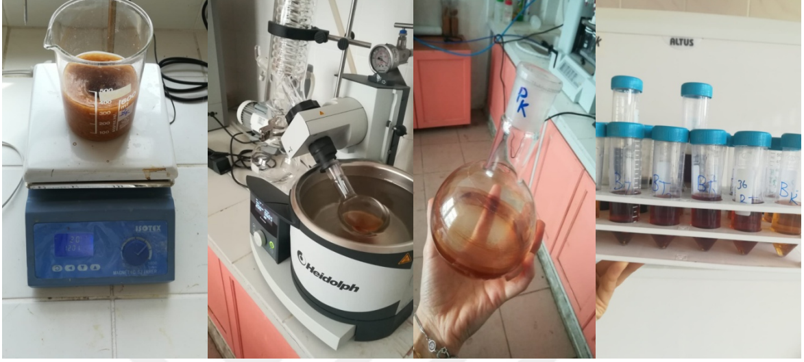
Şekil 18. HPLC analizi için ekstraksiyon süreci
