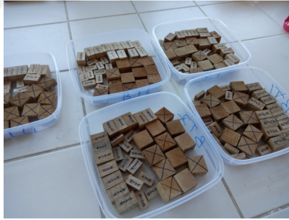
Şekil 13. Yıkanma işlemine hazır deney örnekleri
