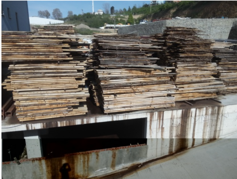
Şekil 12. Yıkanmaya bırakılmış kereste istifi ve tanen akışı (Arsin, 2019).
