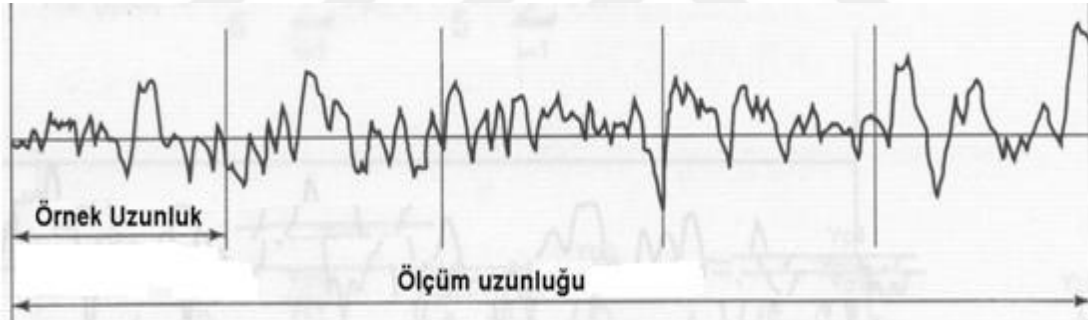
Şekil 16. Yüzey pürüzlülüğü ölçüm uzunluğu ve grafik çıktısı (Ekinci, 2011).
