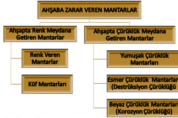
Şekil 10. Oduna arız olan mantarlar (Bozkurt vd., 1993).
