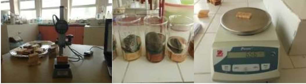
Şekil 10. Boyutsal kararlılık testi örneklerinin boyutlarının ve ağırlıklarının ölçülmesi
