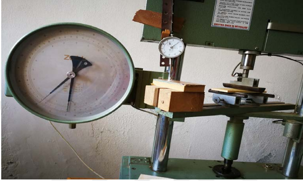
Şekil 33. Eğilme direnci deney düzeneği
