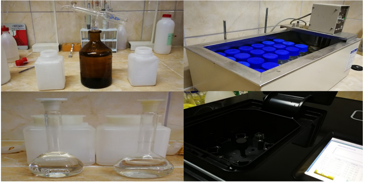
Şekil 35. Şişe yöntemi ile formaldehit emisyonu ölçümü
