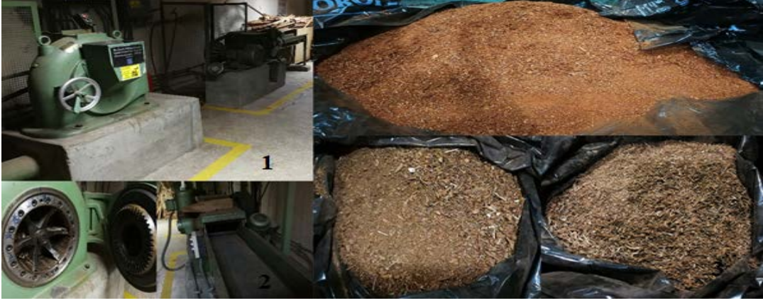
Şekil 22. 1: Kaba yongalam ve ince yongalama makineleri, 2: Yongalama makinelerinin yakından görünüşü, 3: Üstteki Sahil çamı kabuğu, soldan 1. Karaağaç kabuğu, soldan 2. Zuruf
