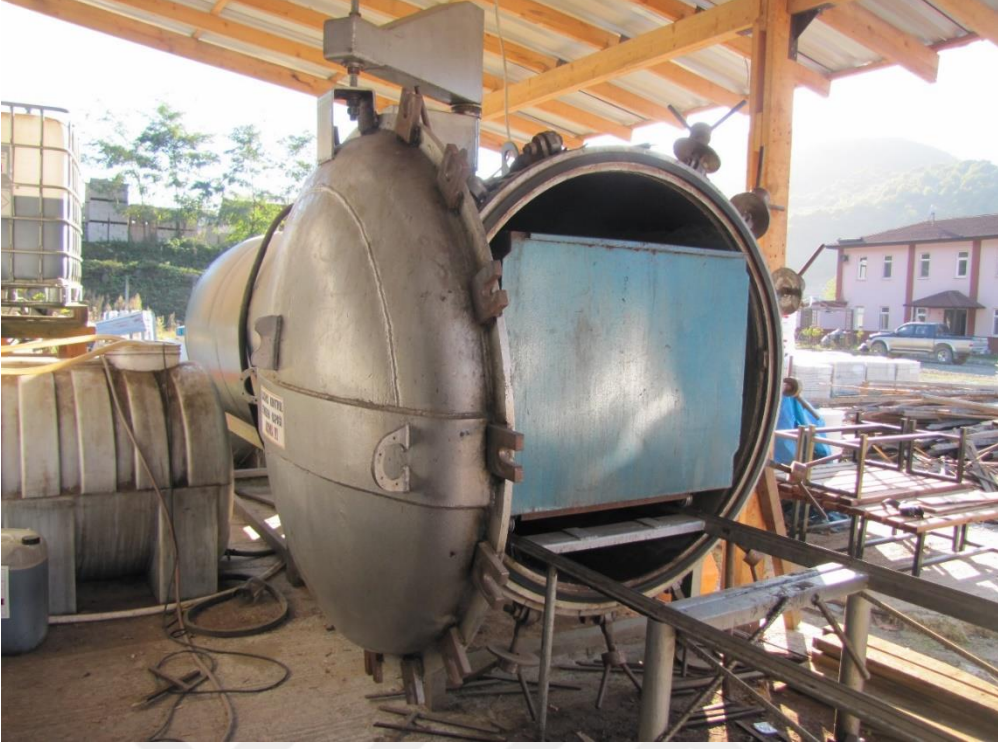
Şekil 3. Vakum-Basınç yönteminin uygulandığı emprenye tesisi
