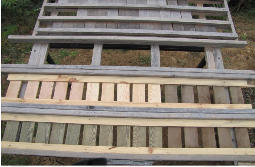
Şekil 6. Örneklerin toprakla temas etmemesini sağlayan düzenek
