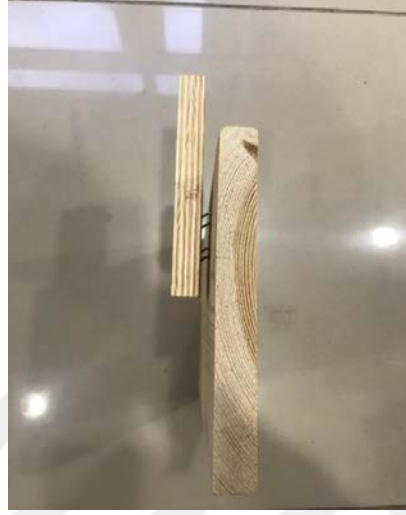
Şekil 25. Zımbanın ana malzemeden çıkışı ve zımba tellerinin eğilmesi
