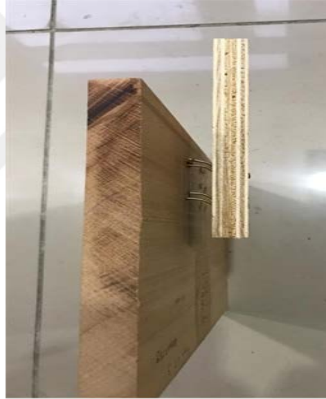
Şekil 37. Zımbanın ana malzemeden çıkışı ve zımba tellerinin eğilmesi
