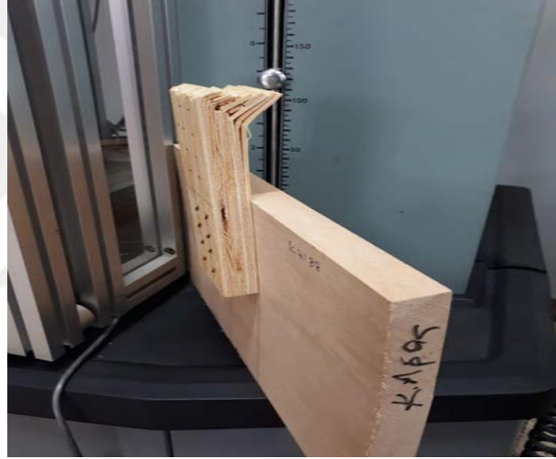
Şekil 53. Takoz tabakaları arasında makaslama
