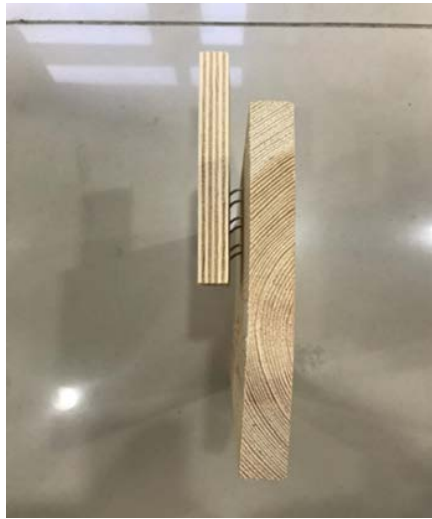
Şekil 28. Zımbanın ana malzemedan çıkışı ve zımba tellerinin eğilmesi
