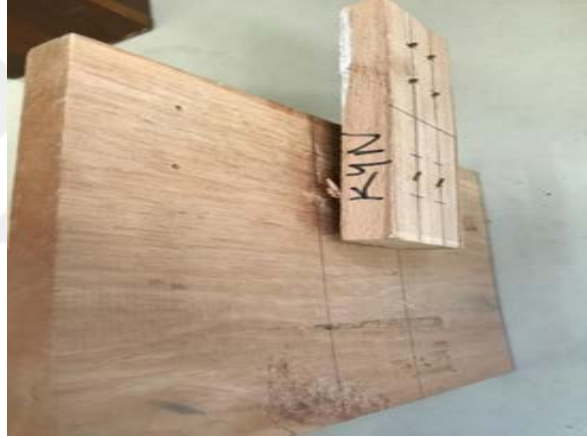
Şekil 65. Zımbanın ana malzemedan ayrılması
