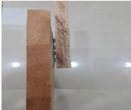
Şekil 71. Zımbanın ana malzemeden çıkışı ve zımba tellerinin eğilmesi
