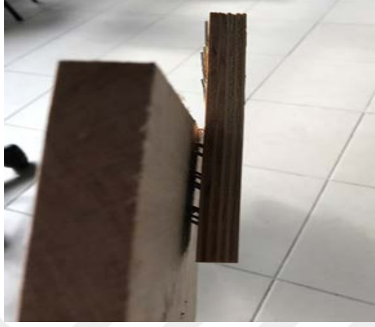
Şekil 68. Zımbanın ana malzemeden çıkışı ve zımba tellerinin eğilmesi
