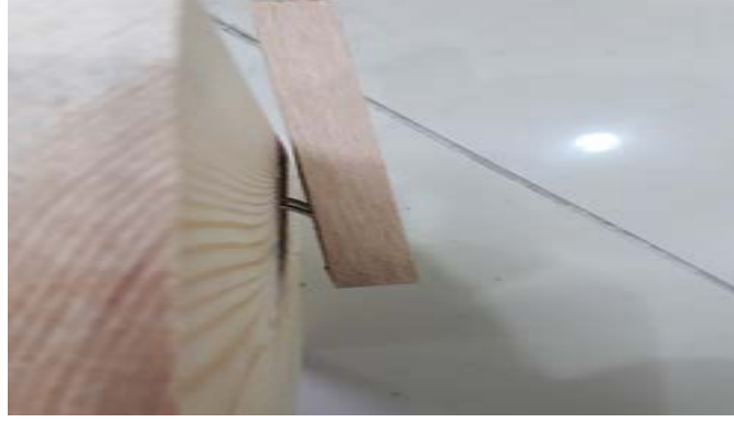
Şekil 72. Zımbanın ana malzemedan çıkışı ve zımba tellerinin eğilmesi
