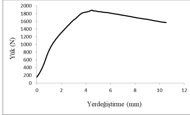
Şekil 32. Tek sıralı iki zımbalı kızılâğaç örneklerine ait tipik yük yer deęiřtirme grafięi
