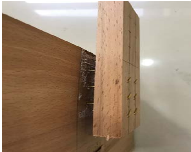
Şekil 84. Birleştirme yerinden tutkal hattının kopması ve zımbanın ana malzemedan çıkması
