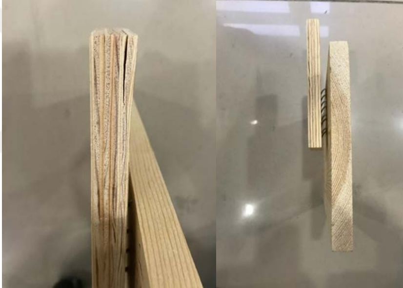
Şekil 29. Takozu oluşturan tabakalar arası makaslama (a), Zımbanın ana malzemeden ayrılması (b)
