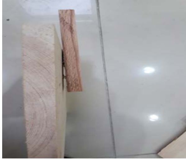
Şekil 74. Birleştirme yerinden ayrılma
