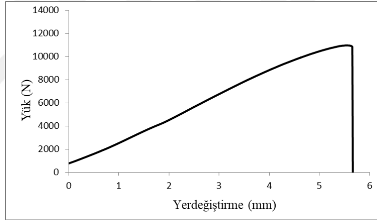
Şekil 94. Tipik bir sadece tutkallı birleştirme yerlerine ait yük-yer deęiştirme grafięi.
