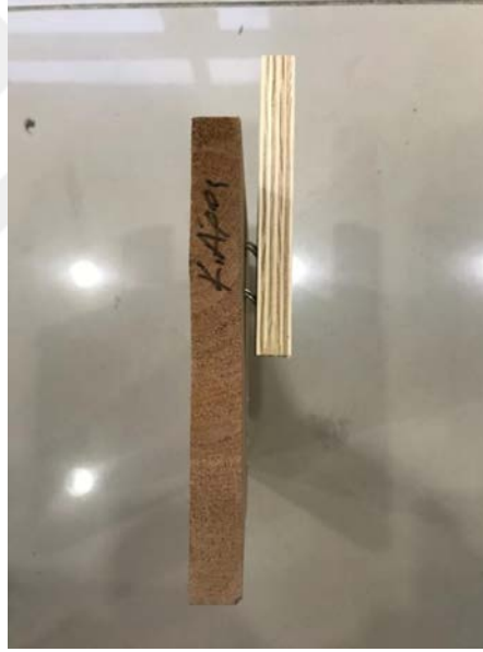
Şekil 31. Zımbanın ana malzemeden çıkışı ve zımba tellerinin eğilmesi
