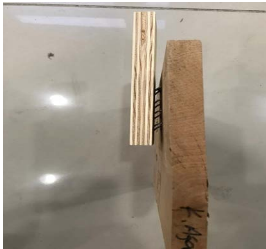
Şekil 35. Takozun tabakaları arasında makaslama
