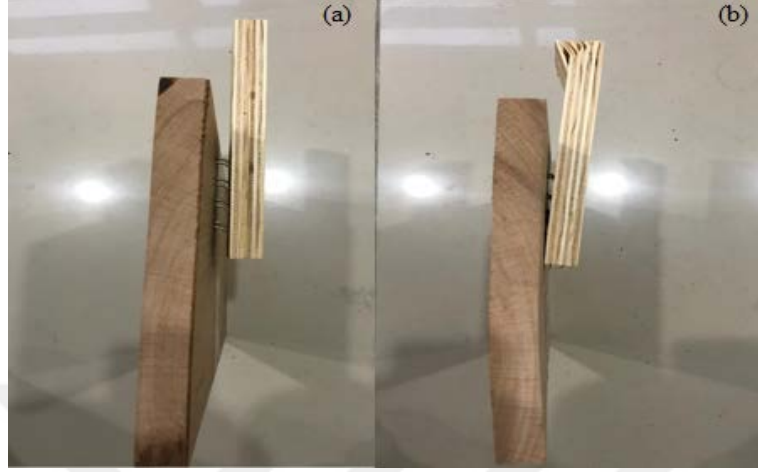
Şekil 41. Zımbanın ana malzemeden çıkışı ve zımba tellerinin eğrilmesi (a), Ana malzemede ve takozda ezikler oluşma (b)
