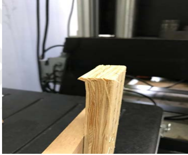
Şekil 51. Takozda ezikler oluşma
