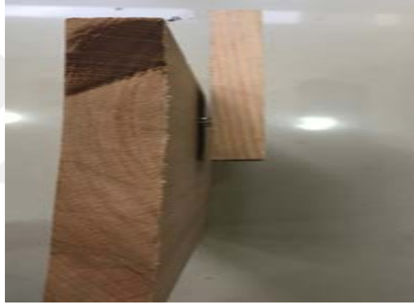
Şekil 80. Zımbanın ana malzemeden ayrılması
