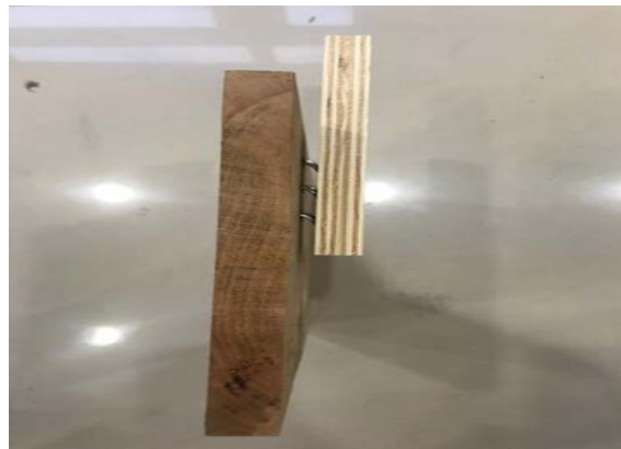
Şekil 33. Zımbanın ana malzemeden ıkması ve zımba tellerinin eęilmesi
