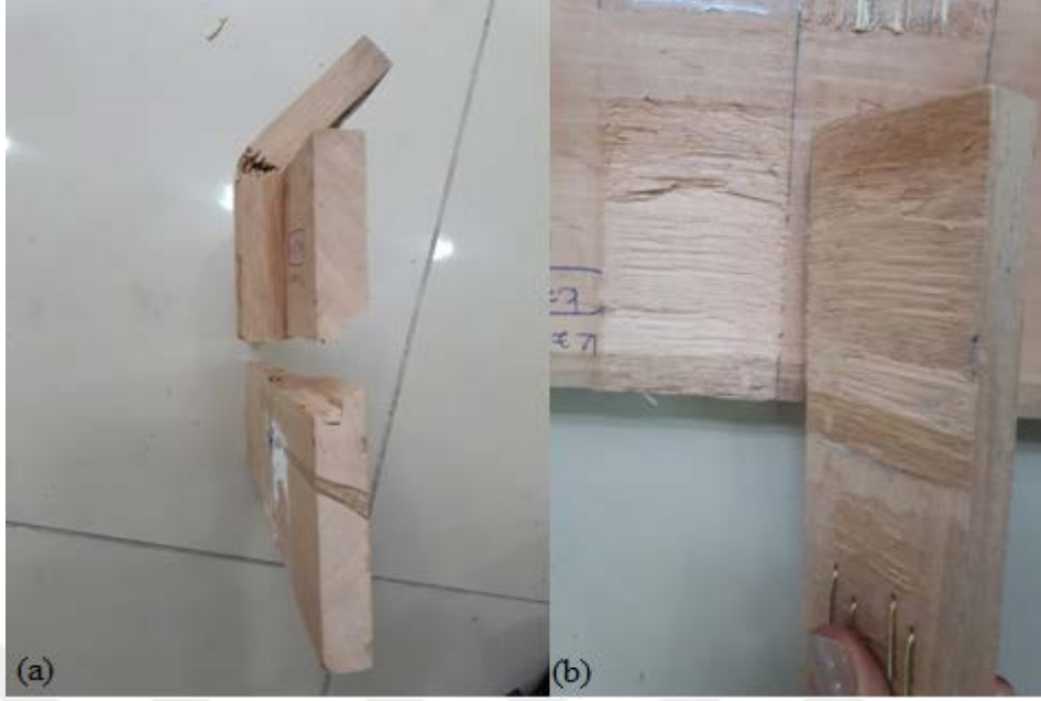
Şekil 90. Takoz malzemesinin ve ana malzemenin kırılması (a), Birleştirme yerinden ayrılma (b)
