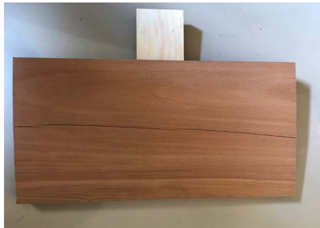
Şekil 56. Ana malzemedan kırılma
