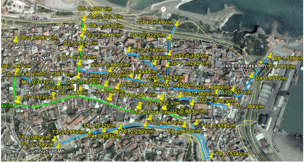
Ek Şekil 1. Tanjant ve Devlet Sahil Yolu arasında bulunan bölgede GSM 900MHZ bandında elde edilen ortalama elektrik alan şiddeti ölçüm değerlerinin harita üzerinde gösterimi
