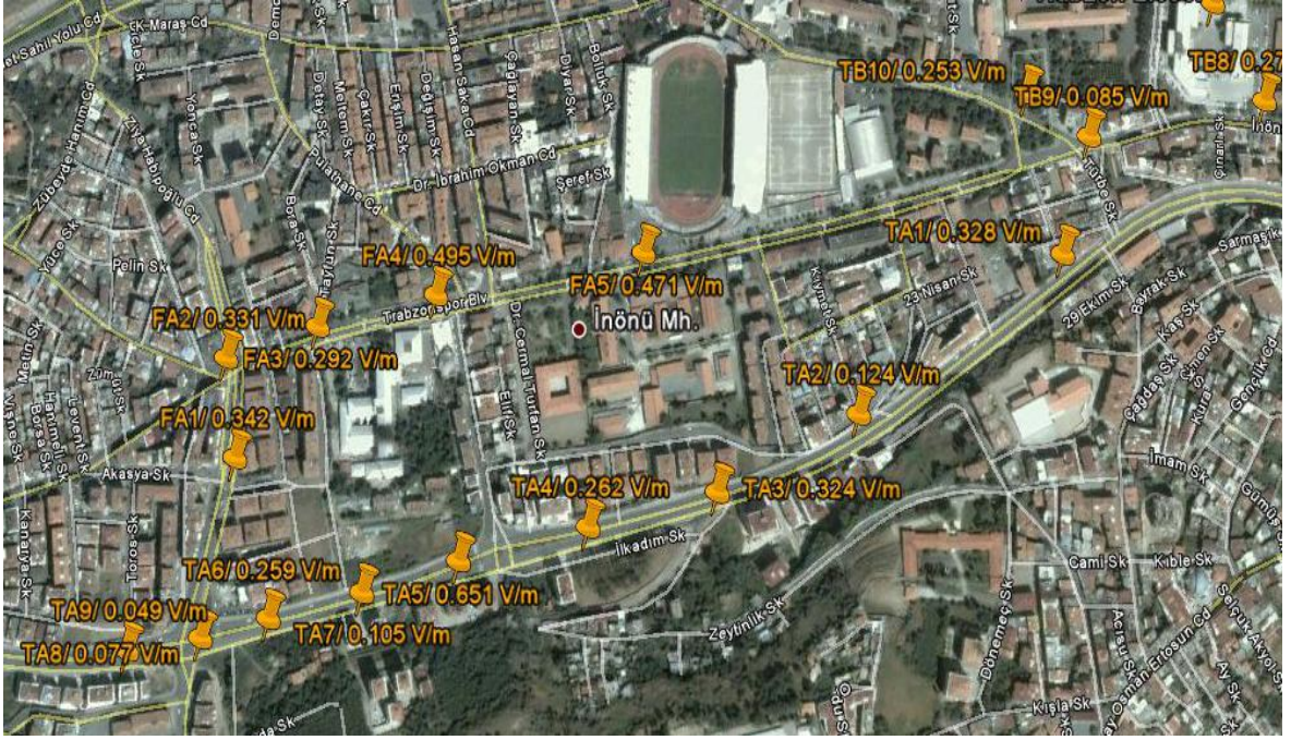
Ek Şekil 9. Yavuz Selim Bulvarı ve İnönü Caddesi boyunca 2GHz bandında elde edilen ortalama elektrik alan şiddeti ölçüm değerlerinin harita üzerinde gösterimi
