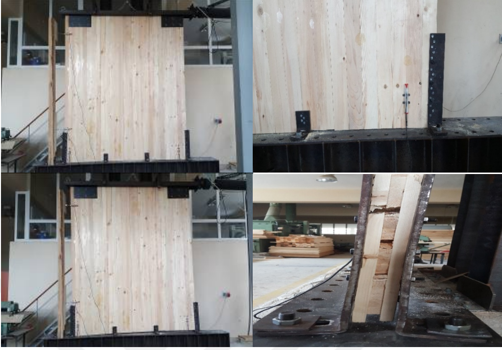
Şekil 56. Deney esnasında 5. grupta meydana gelen deformasyonlar
