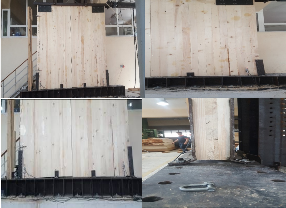
Şekil 61. Deney esnasında 10. grupta meydana gelen deformasyonlar
