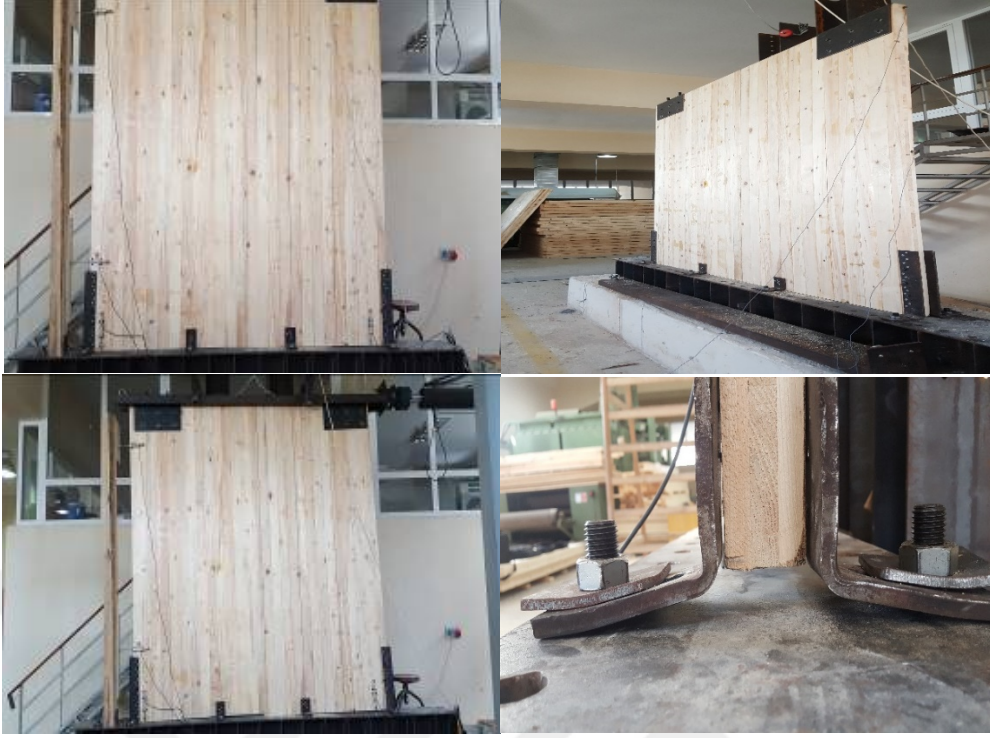
Şekil 62. Deney esnasında 11. grupta meydana gelen deformasyonlar
