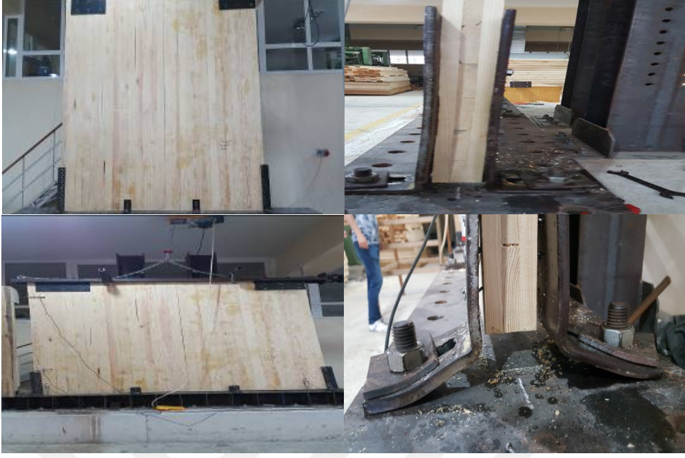
Şekil 54. Deney esnasında 3. grupta meydana gelen deformasyonlar
