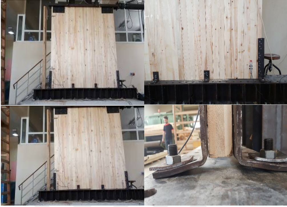
Şekil 58. Deney esnasında 7. grupta meydana gelen deformasyonlar
