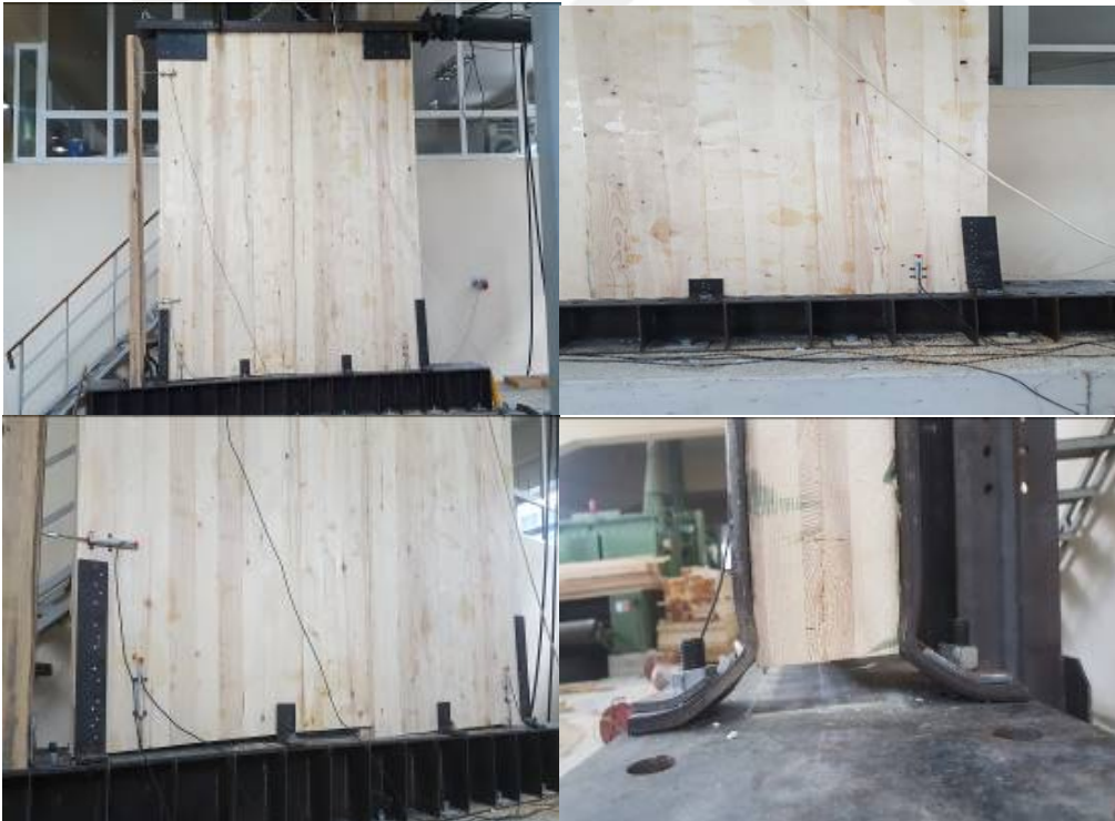
Şekil 59. Deney esnasında 8. grupta meydana gelen deformasyonlar
