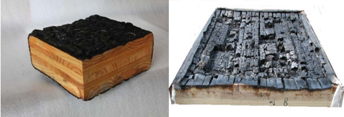
Şekil 13. Yangın testi sonrası CLT
