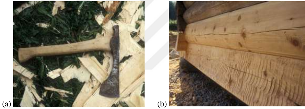
Şekil 77. (a) Norveçli ustaların ortaçağda kullandıkları ”sprett-telgjing” olarak adlandırılan bir çeşit balta. (b) kütük evlerde bu balta kullanılarak yapılan bir eşik kirişi yüzeyi (URL-2).
