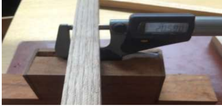
Şekil 15. Deney örneklerinin boyutlarının ölçülmesi
