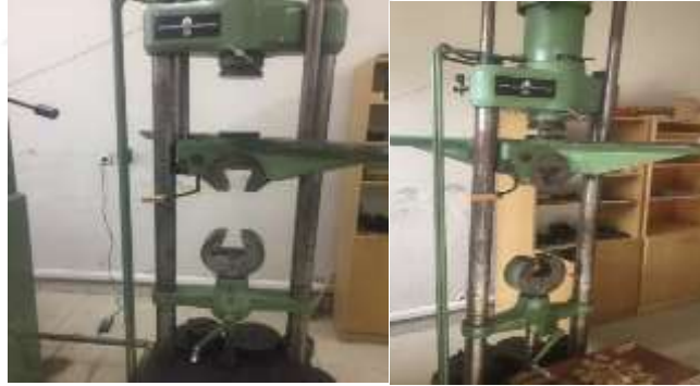
Şekil 16. Liflere paralel yönde basınç direnci
