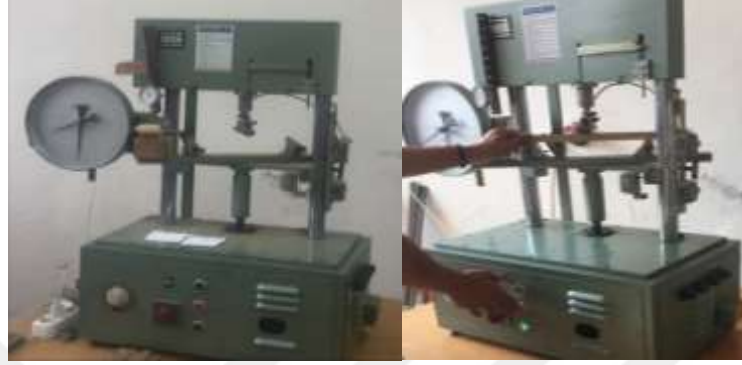
Şekil 17. Statik eğilme direnci ve eğilmeye elastikiyet modülü
