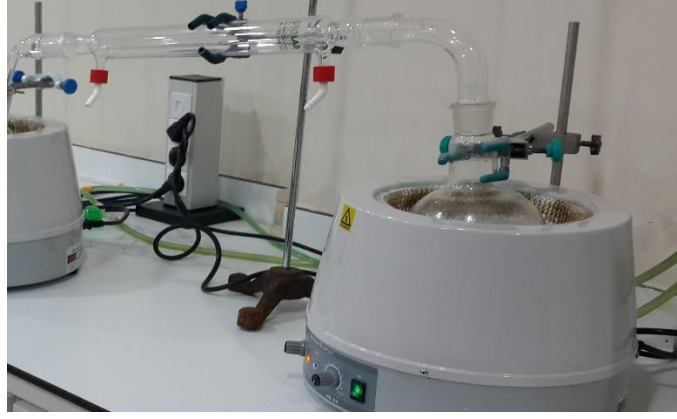
Şekil 42. Buhar balonu ve mantolu ısıtıcı (Foto: İ. Aydın, 2016).
