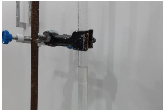
Şekil 44. Bürette terebentinin birikmesi (Foto: İ. Aydın, 2016).
