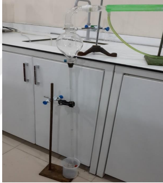
Şekil 43. Soğutucudan geçen terebentinin ayırma hunisinden geçip bürette ve destilasyondan buharlaşan suyun beherde birikmesi (Foto: İ. Aydın, 2016).
