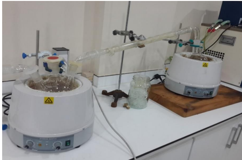
Şekil 41. Buhar balonundan 3 boyunlu balona soğutucu vasıtasıyla buharın geçmesi (Foto: İ. Aydın, 2016).
