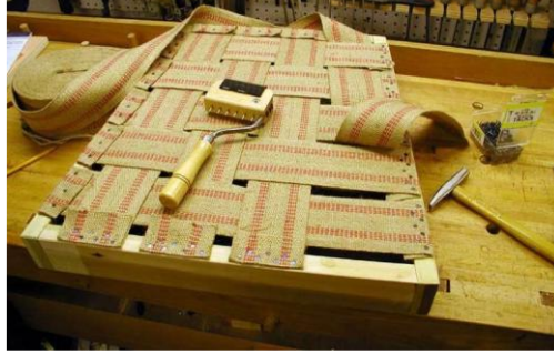
Şekil 16. Kolan üzerine yaysız döşeme ( MEB,2013).
