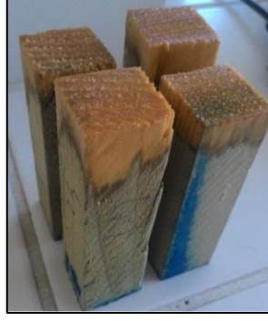
Şekil 13. Enine kesitlerin epoksi reçinesi ile kaplanması
