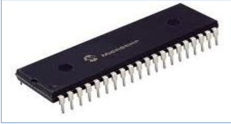
Şekil 13. Microchip firmasının ürettiği 18F452 model bir mikrodeneleyici
