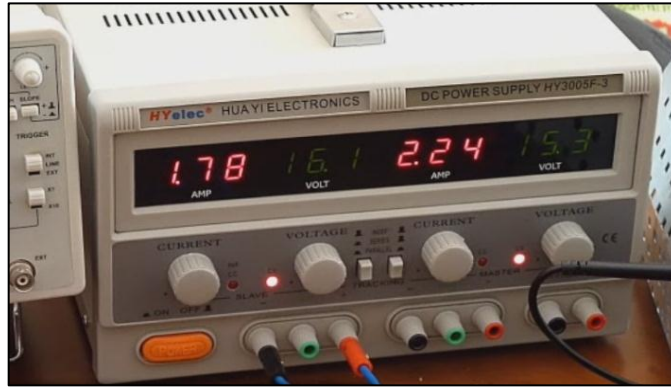
Şekil 22. Değişken gerilimi tedarik eden "Huayi Electronics" firması tarafından üretilmiş DA güç kaynağı
