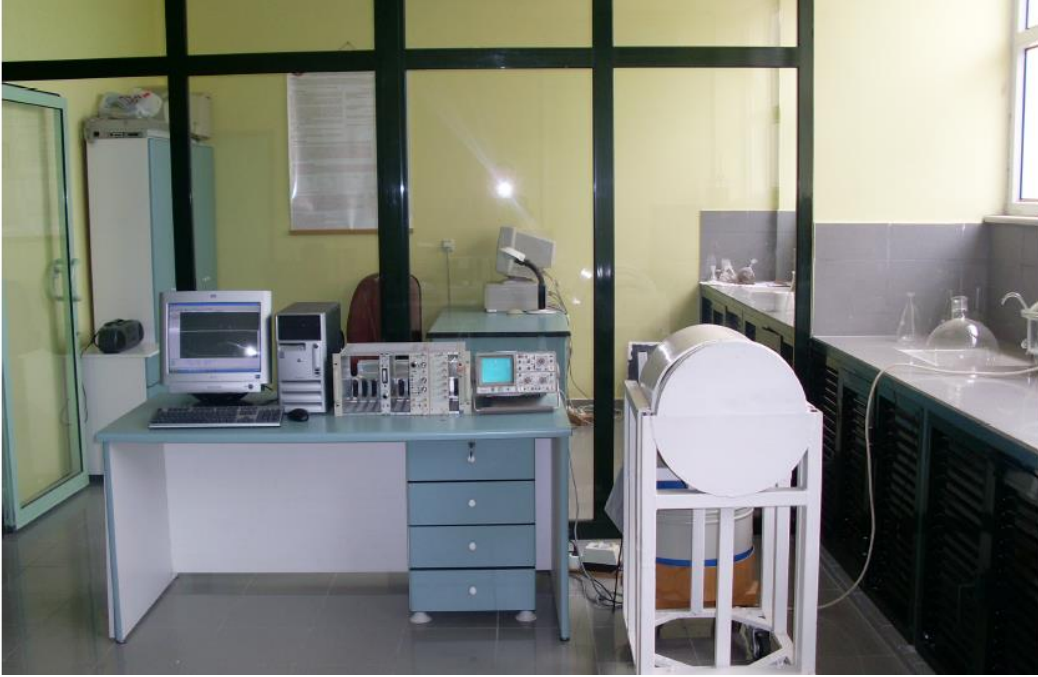
Şekil 14. HPGe Gama spektrometre sisteminin genel görünüşü
