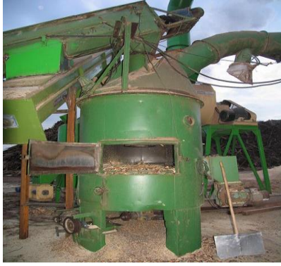
Şekil 9. Endüstriyel yonga temizlemede kullanılan rüzgârlı ve diskli elekler (Kalaycıoğlu ve Özen, 2012)
