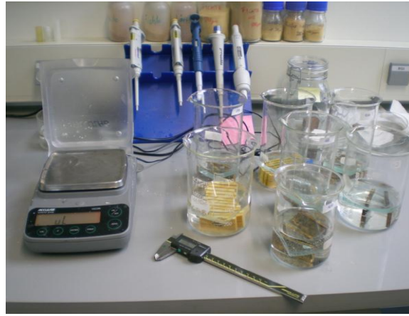
Şekil 23. Boyutsal kararlılık testi örneklerinin boyutlarının ve ağırlıklarının ölçülmesi
