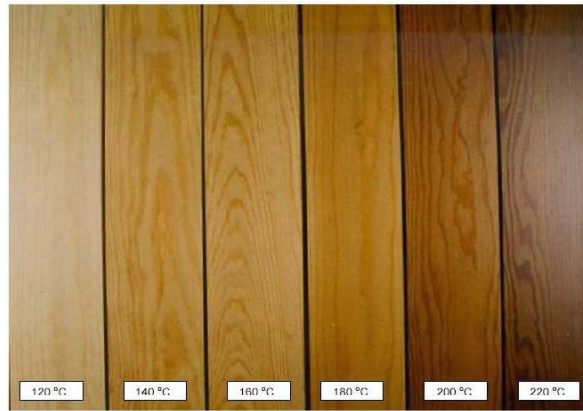
Şekil 11. Isıl işlem uygulanmış çamda sıcaklığın artmasıyla meydana gelen renk değişimi (URL-1, 2003)
