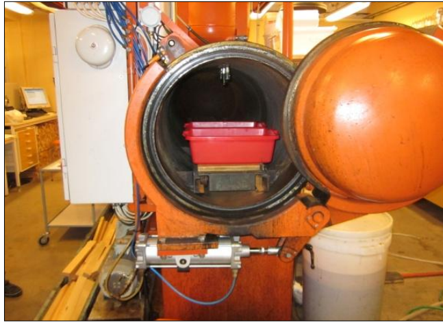
Şekil 19. Örneklerin dolu hücre yöntemiyle emprenyesi
