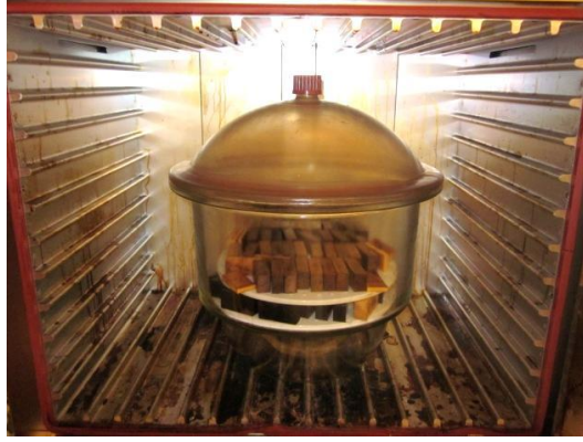
Şekil 21. Emprenyeli örneklerin desikatör içerisinde etüvde bekletilmesi
