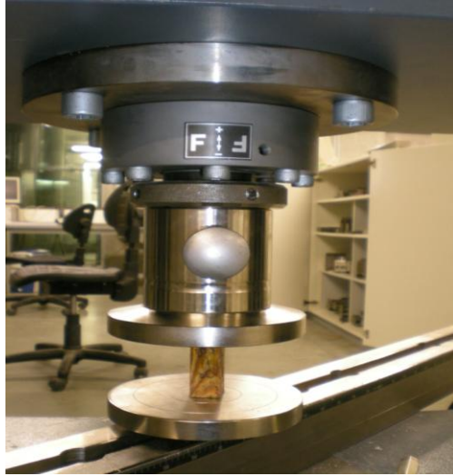
Şekil 28. Üniversal test makinesinde liflere paralel basınç direnci
