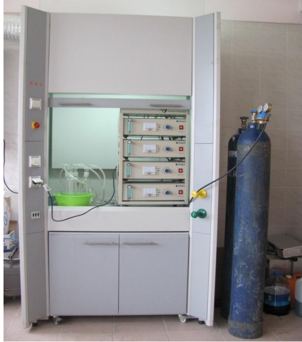
Şekil 9. Örneklerin ozonla remidasyonu
