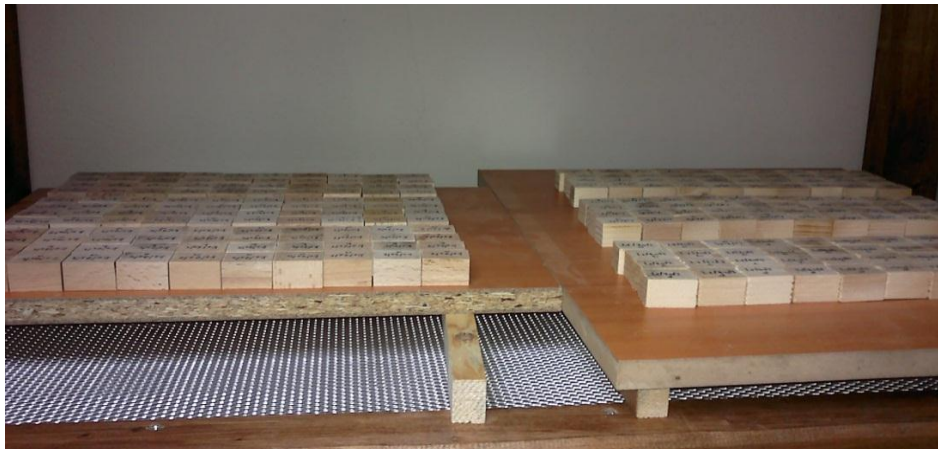
Şekil 31. İklimlendirme işlemleri yapılan yoğunluk örnekleri
