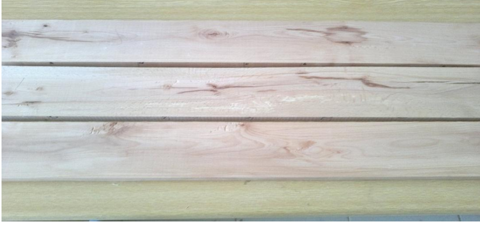
Şekil 36. Zımparalanmış Doğu Kayını deney örnekleri
