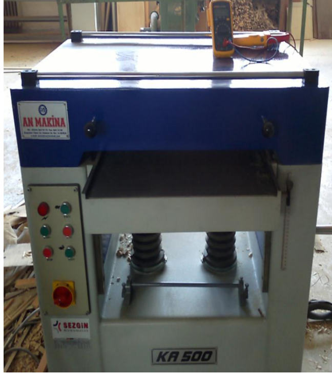
Şekil 32. Rendeleme işleminde kullanılan kalınlık makinesi
