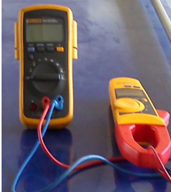
Şekil 33. Rendeleme işleminde motorun çektiği akımı ve gerilimi belirlemek için kullanılan ampermetre ve voltmetre
