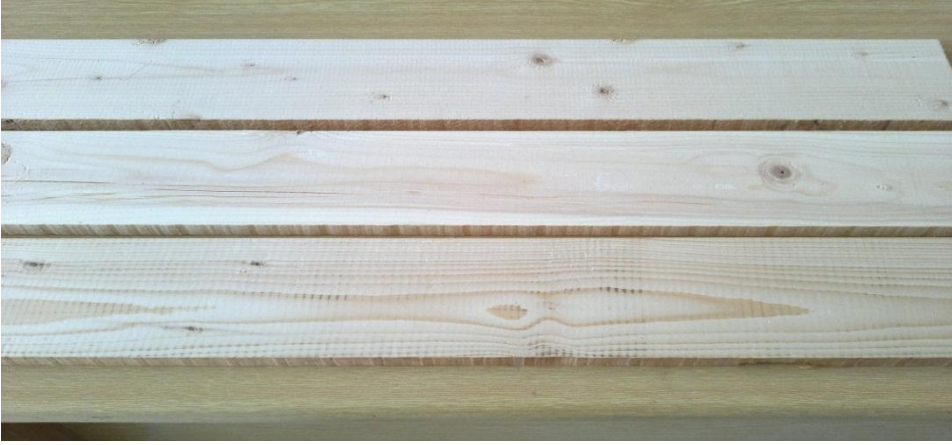
Şekil 37. Zımparalanmış Doğu Ladini deney örnekleri
