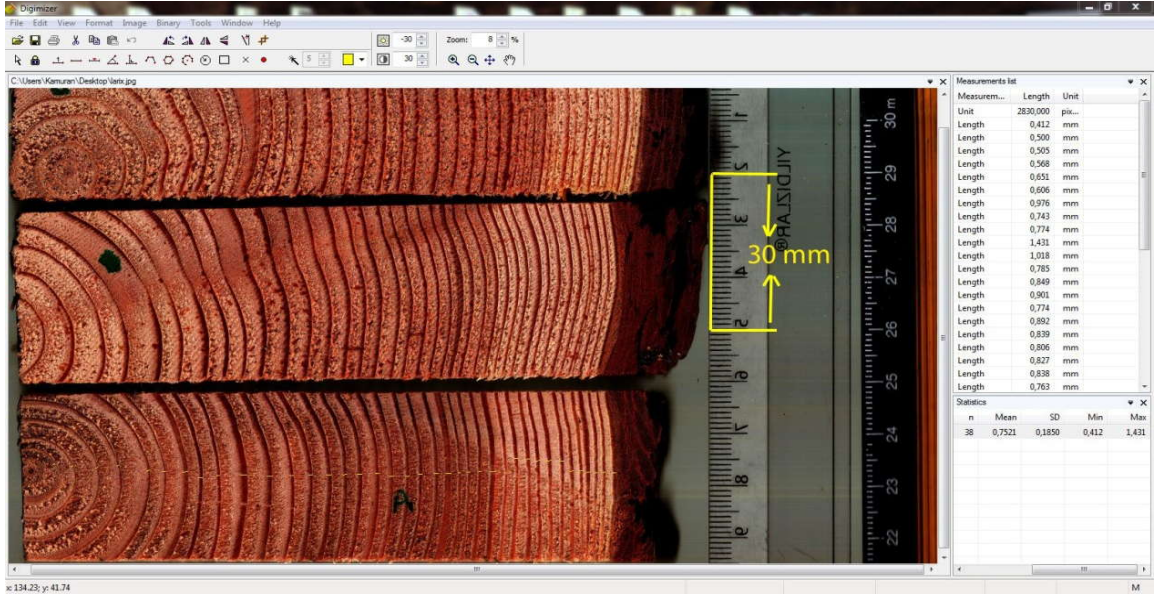
Şekil 12. Digimizer ile ölçüm yapmak.
