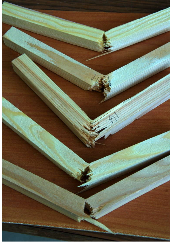
Şekil 32. Avrupa melezi odununun Dinamik eğilme direnci testi sonrası görünümü.
