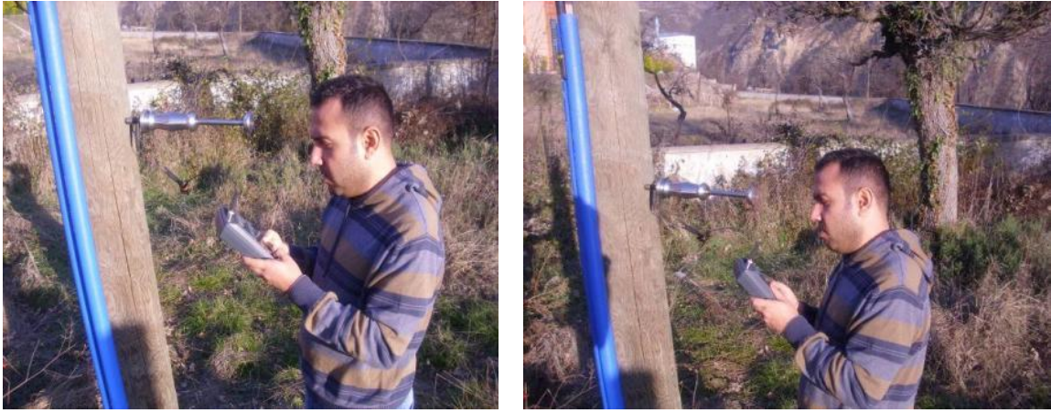
Şekil 20. Odun rutubet ölçer cihazı ile tel direklerindeki rutubetin arazide ölçülmesi
