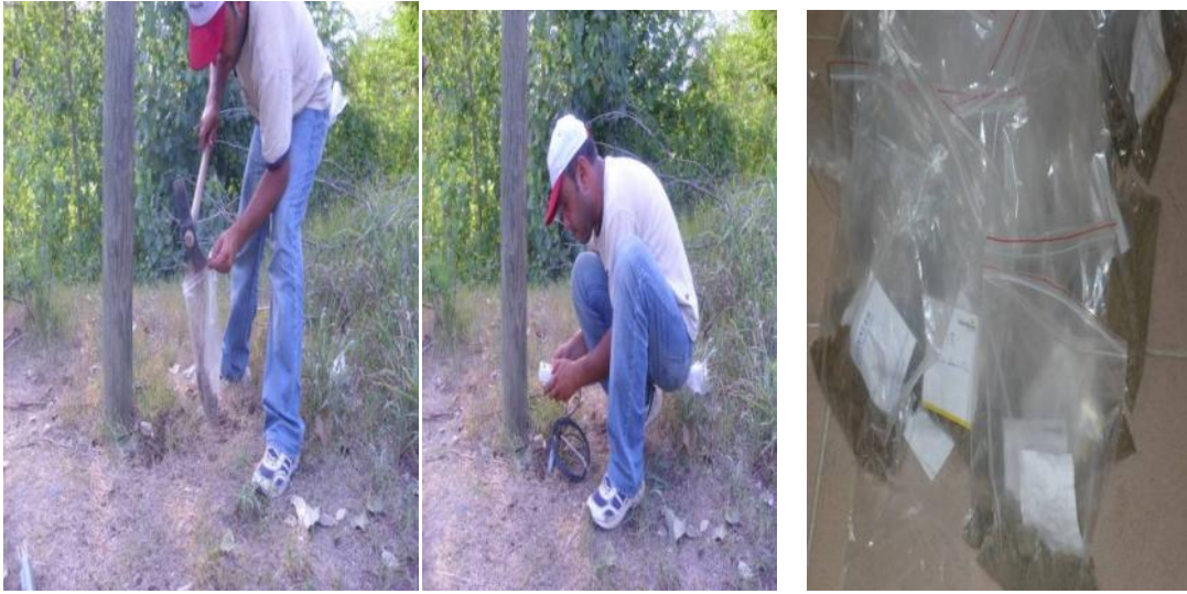
Şekil 17. Toprak örneklerinin alınması ve toprak neminin ölçülmesi
