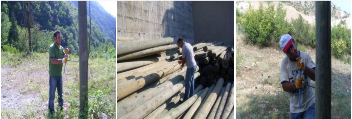
Şekil 19. Çalışma alanında ve depolarda bulunan tel direklerinden artım burgusu örneği alma
