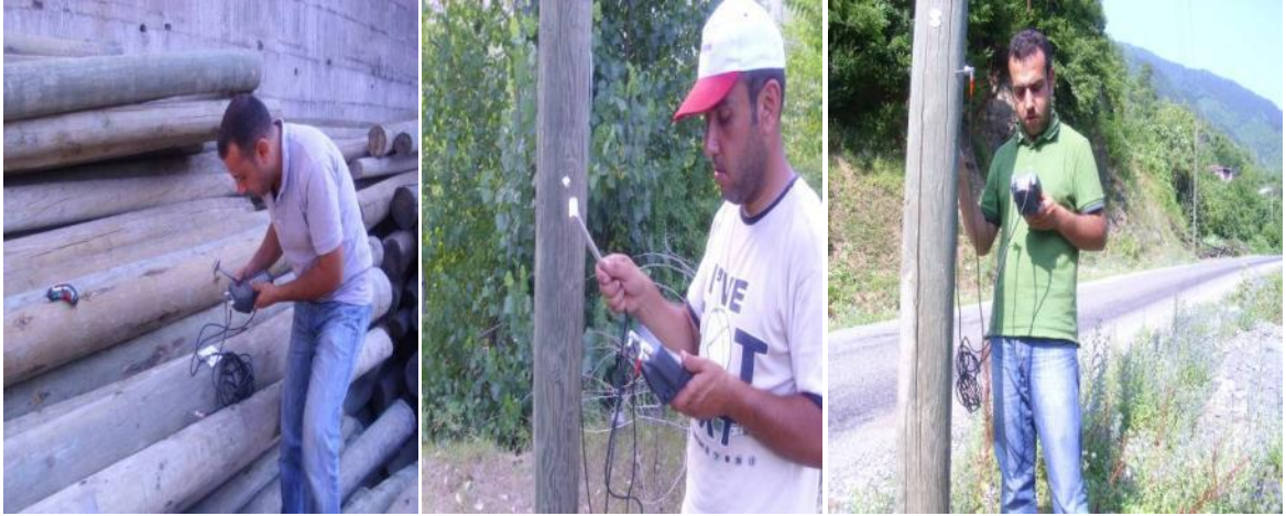
Şekil 25. Artvin ÇEDAŞ deposu ve çalışma alanında Mikroçekiç cihazıyla yapılan ölçümler
