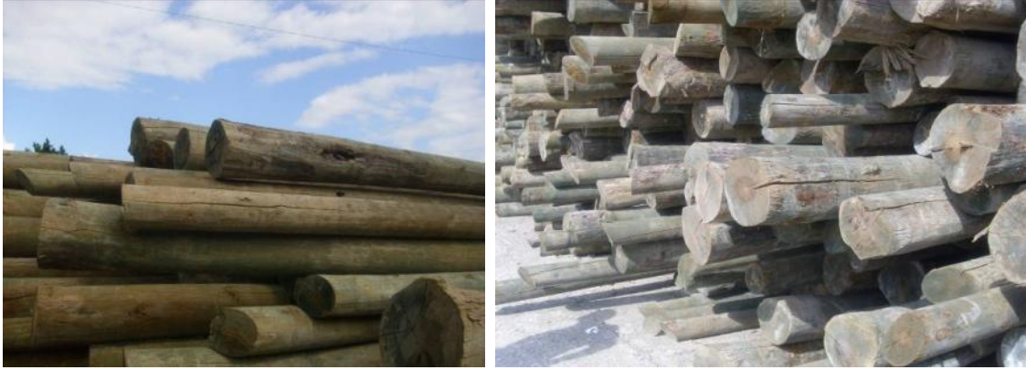
Şekil 48. Trabzon TEDAŞ Arsin Deposunda henüz kullanılmaya başlanmamış tel direklerindeki elektrik aksamlarının takılması için gerekli olan deliklerin açılmadığının tespit edilmesi
