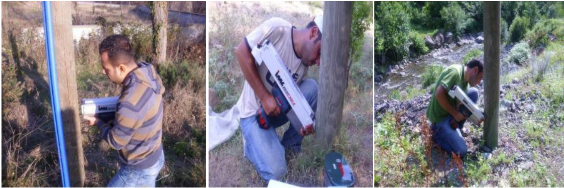
Şekil 24. Rezistograf cihazıyla tel direklerinin göğüs seviyesinin ve toprakla temas eden kısımlarının (cihaza ait 45° lik açı aparatı yardımıyla) incelenmesi
