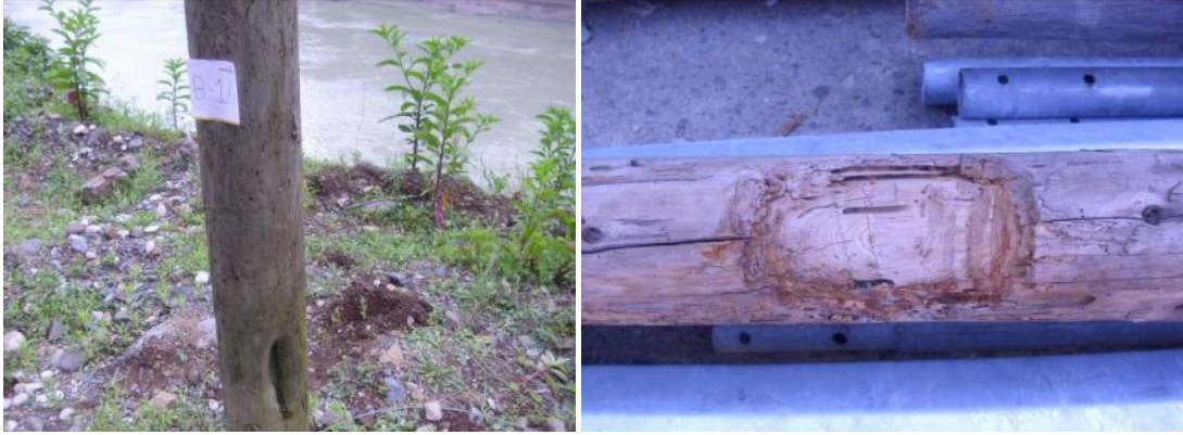
Şekil 42. Artvin-Borçka yöresinde ve ÇEDAŞ deposunda yoğun bir şekilde böcek tahribatına uğramış tel direği
