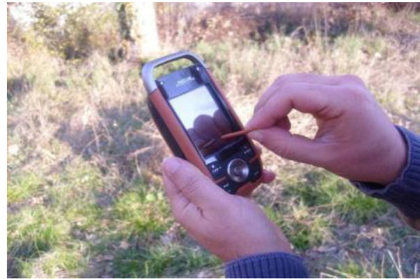
Şekil 10. Belirlenen alanlar ve tel direklerinin yerlerinin (koordinat ve rakım) GPS (MAGELLAN) ile tespiti
