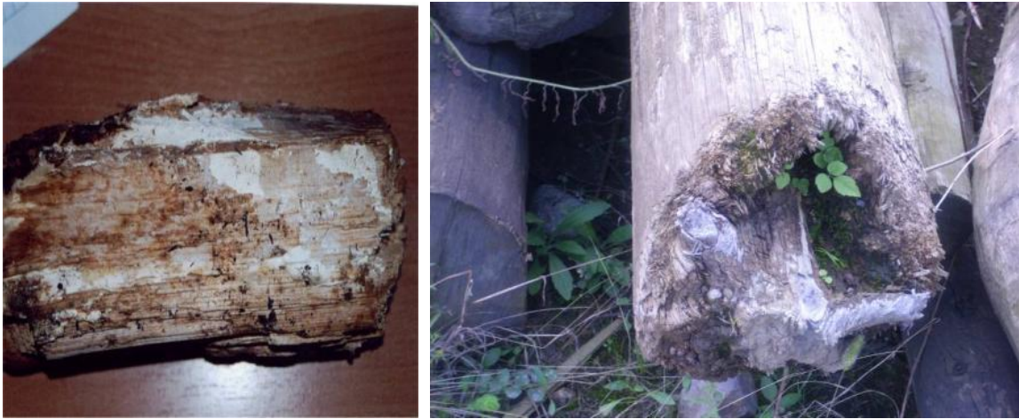
Şekil 35. TEDAŞ Trabzon Bölge Müdürlüğü Arsin Deposunda CCA ile emprenyeli tamamen misellerle sarılmış bir tel direği ve başka bir tel direğinde tespit edilen beyaz çürüklük
