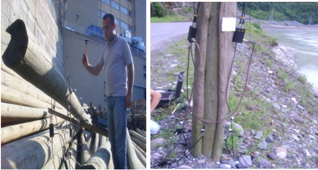
Şekil 22. Çalışma alanındaki (görsel olarak tel direği kullanıma uygun değil) ve ÇEDAŞ deposundaki (solda) tel direklerinden Fakopp 3D Akustik Tomografi cihazıyla ölçüm yapılması
