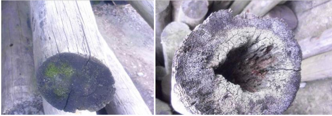
Şekil 37. TEDAŞ Trabzon Bölge Müdürlüğü Arsin Deposunda atıl haldeki tel direklerinde görülen yumuşak çürüklük ( Esmer ve Beyaz Çürüklükle bir arada oluşmuş)
