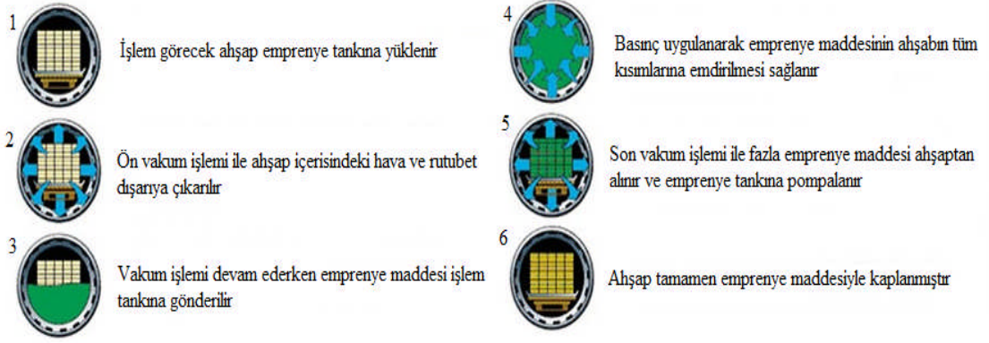
Şekil 7. Emprenye işlemi aşamaları
