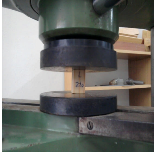
Şekil 12. Liflere paralel yönde basınç direnci deneyinin uygulandığı
