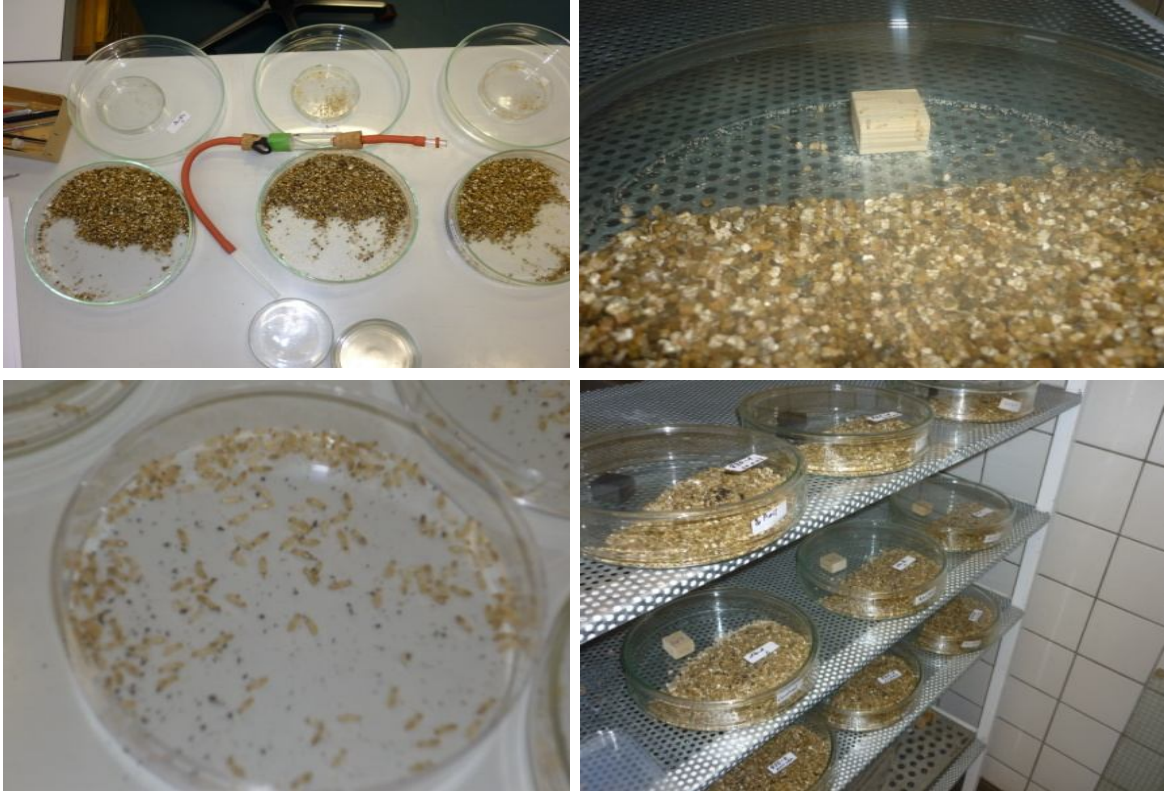
Şekil 25. Termit testi ve vermiculite mineral ortamı
