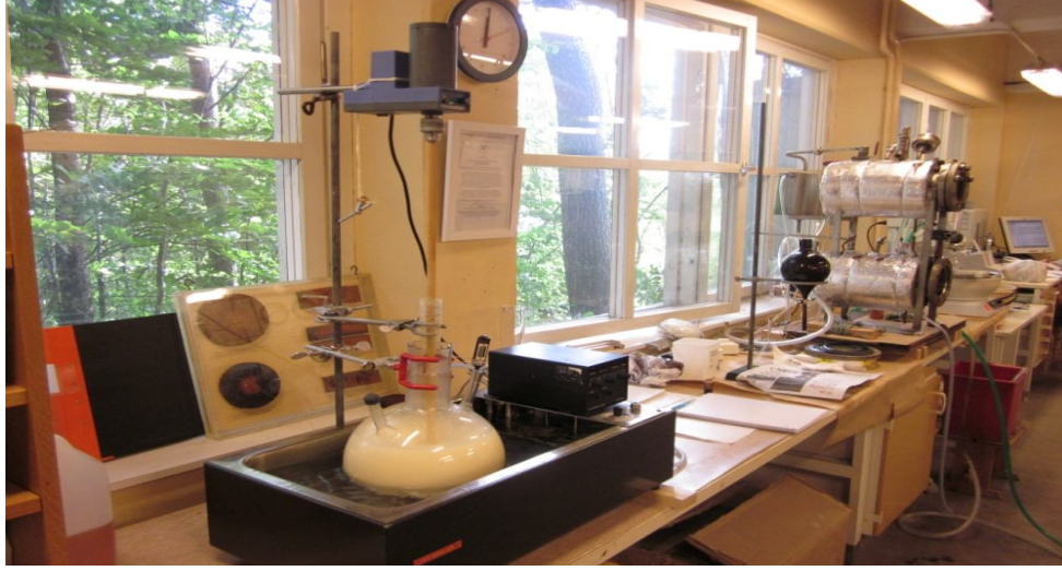
Şekil 18. Epoksitlendirilmiş keten yağının hazırlanması
