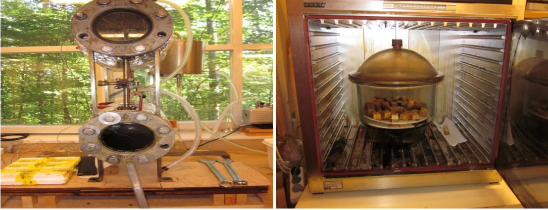
Şekil 20. Emprenye sistemi (boş hücre metodu ile ELO muamelesi) ve desikatörde asetik asit uygulaması
