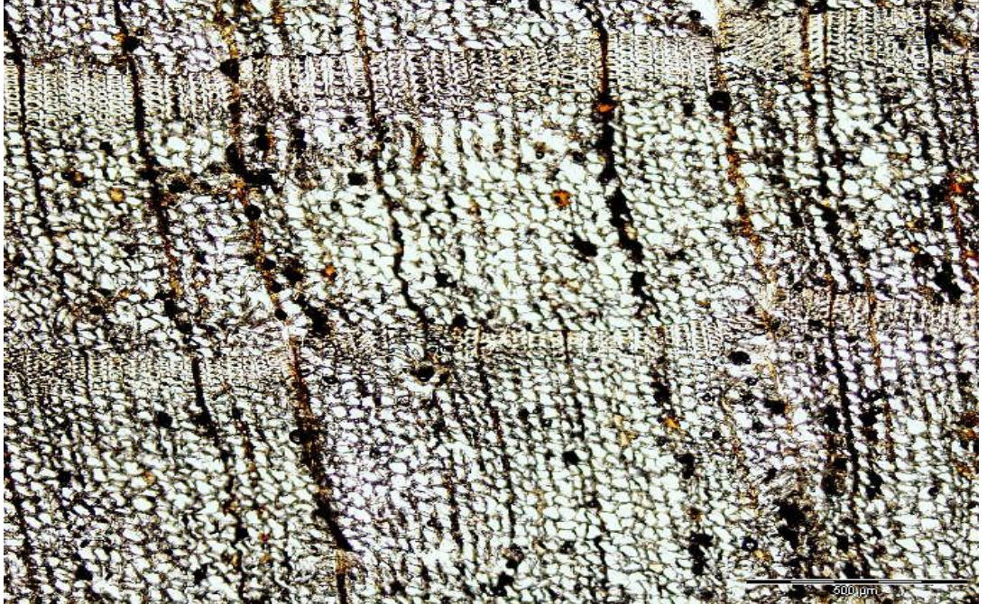
Şekil 37. % 10 biyo-yağ+ELO ile emprenye edilen odun örneğinin mikroskop görüntüsü
