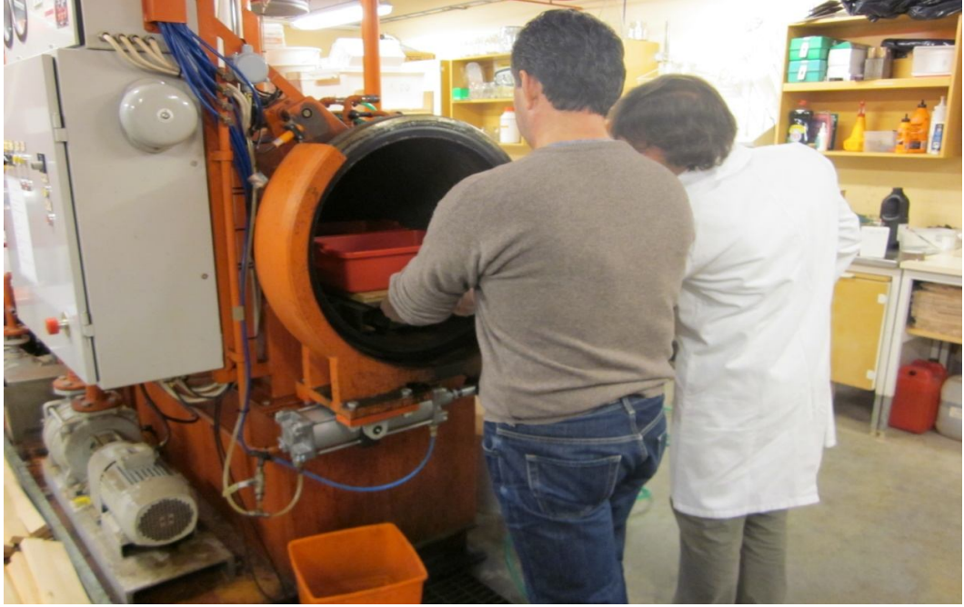
Şekil 19. Emprenye sistemi (dolu hücre yöntemi)
