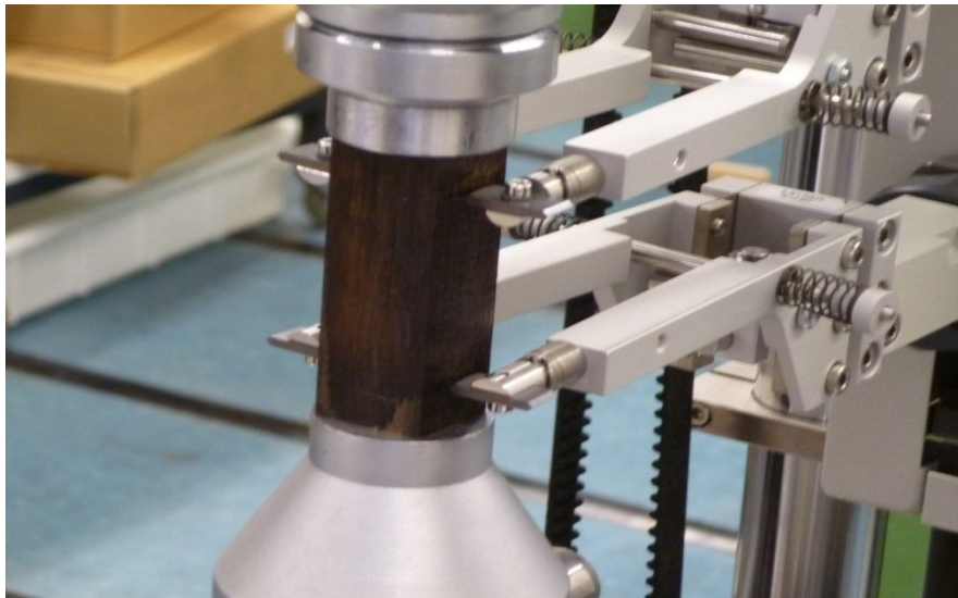
Şekil 27. Üniversal test makinesinde liflere paralel basınç direnci
