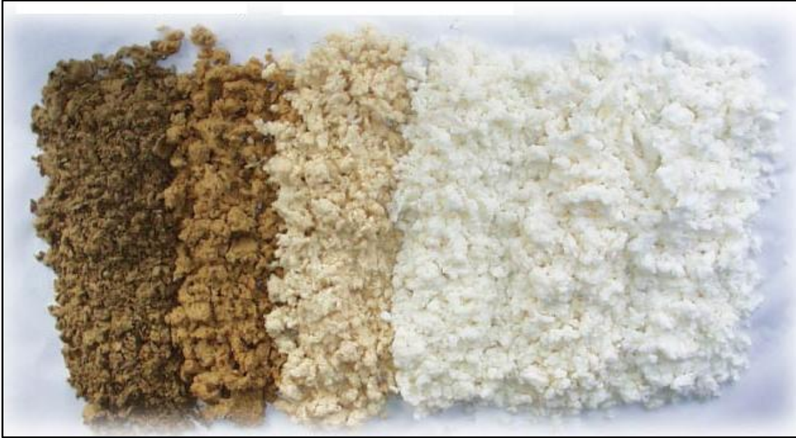
Şekil 7. Kraft hamrunun kademeli olarak ağartılması sonucunda elde edilen renk değişimi
