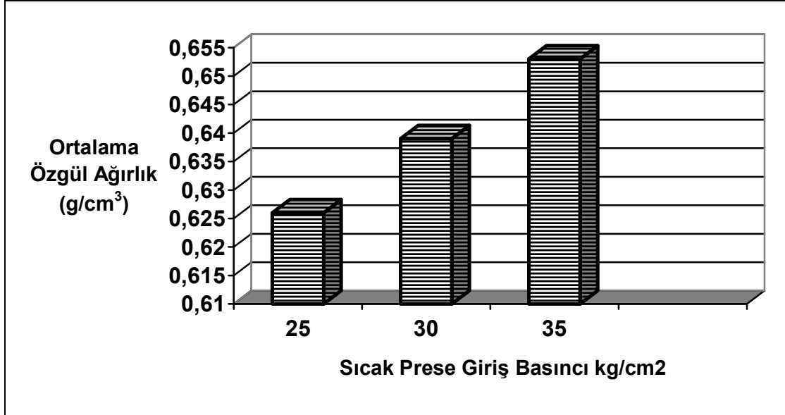
Şekil 1. Sıcak prese giriş basıncının ortalama özgül ağırlık üzerine etkisi
