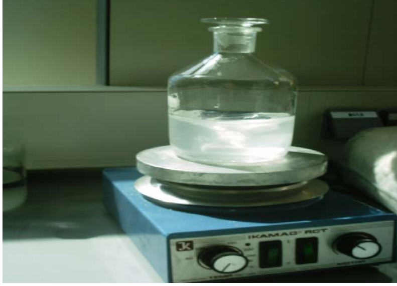
Şekil 30. Selülozun DMAc/LiCl çözeltisinde çözünmesi
