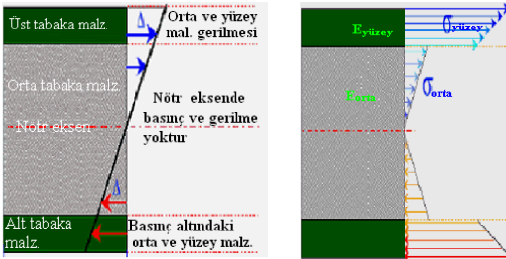
Şekil 5. Sandviç panellerde elastikiyet modülü ve eğilme direncinin kalınlık eksenindeki değişimi [11].
