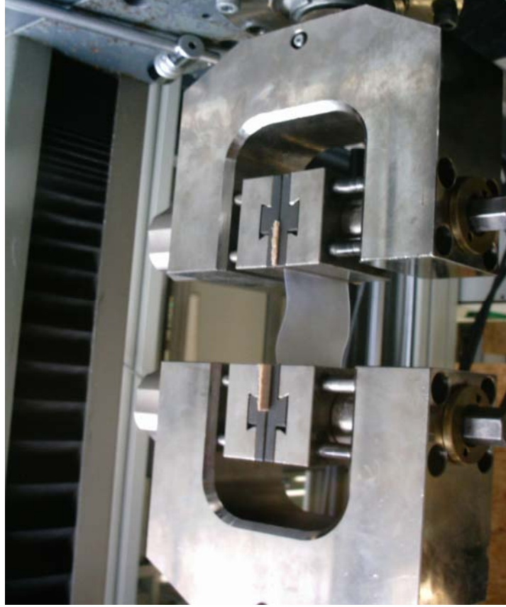
Şekil 42. Zwick 20 kN üniversal test makinesine yerleştirilmiş şerit selüloz film
