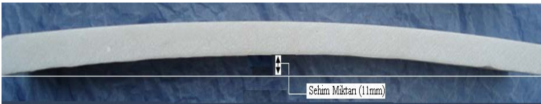
Şekil 32. Odunsu materyal kullanılmadan üretilen polyester (PL) levhada meydana gelen şekil bozukluğu
