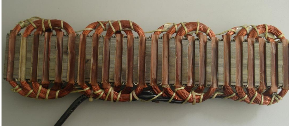
Şekil 2.3. Oluşturulan tek tabakalı primer sargı düzeni
