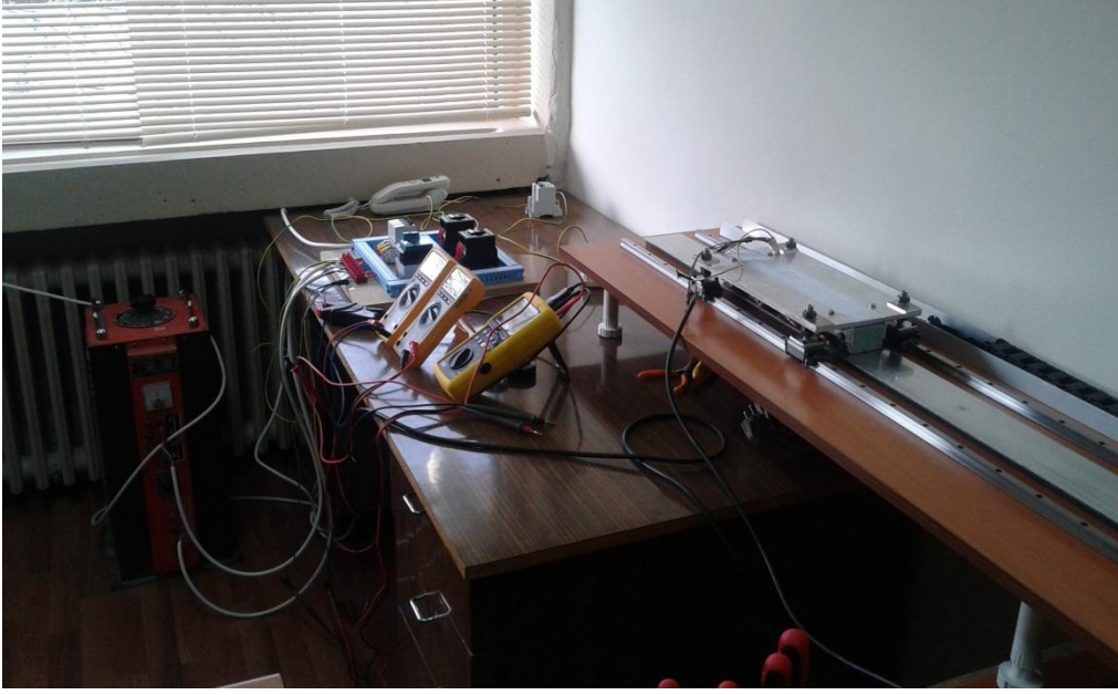
Şekil 2.10. Eşdeğer devre parametrelerinin çıkarılması için gerekli deneysel düzenek
