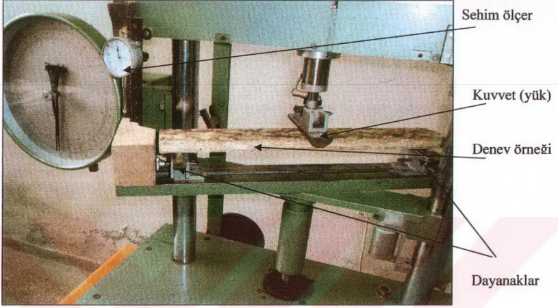
Şekil 21. Eğilme direnci ve elastikiyet modülü deney düzeneği
