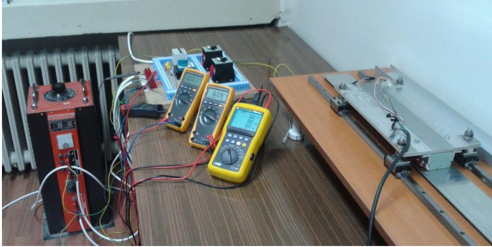
Şekil 2.5. Eşdeğer devre parametrelerinin çıkarılması için gerekli deneysel düzenek
