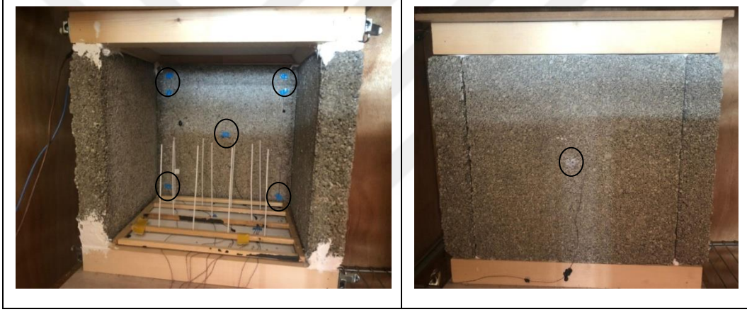
Şekil 30. Kontrol odasındaki uygulamada mini kabin içerisine ve dışına yerleştirilen ısı çiftleri
