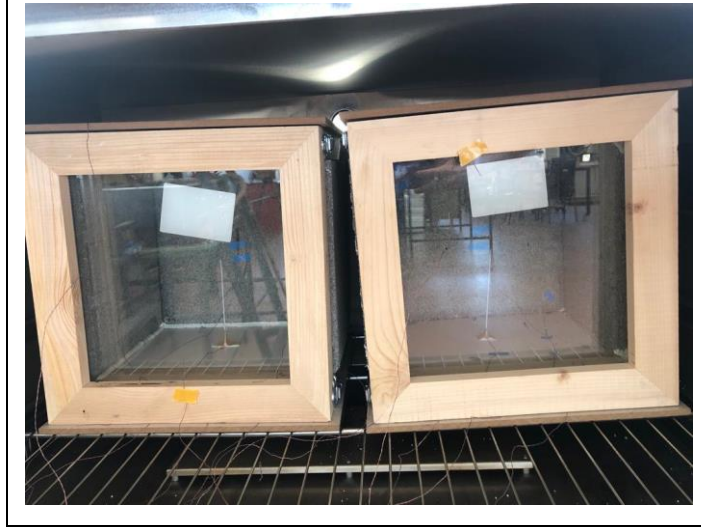
Şekil 31. Fırın içi uygulamada ısı çiftlerinin mini kabinlere yerleştirilmiş hali
