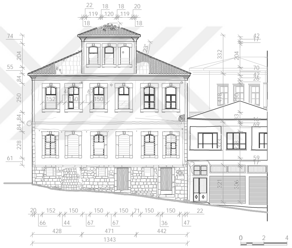
Şekil 6.2. 110 ada 16 parselde ait rölöve çizimi.
