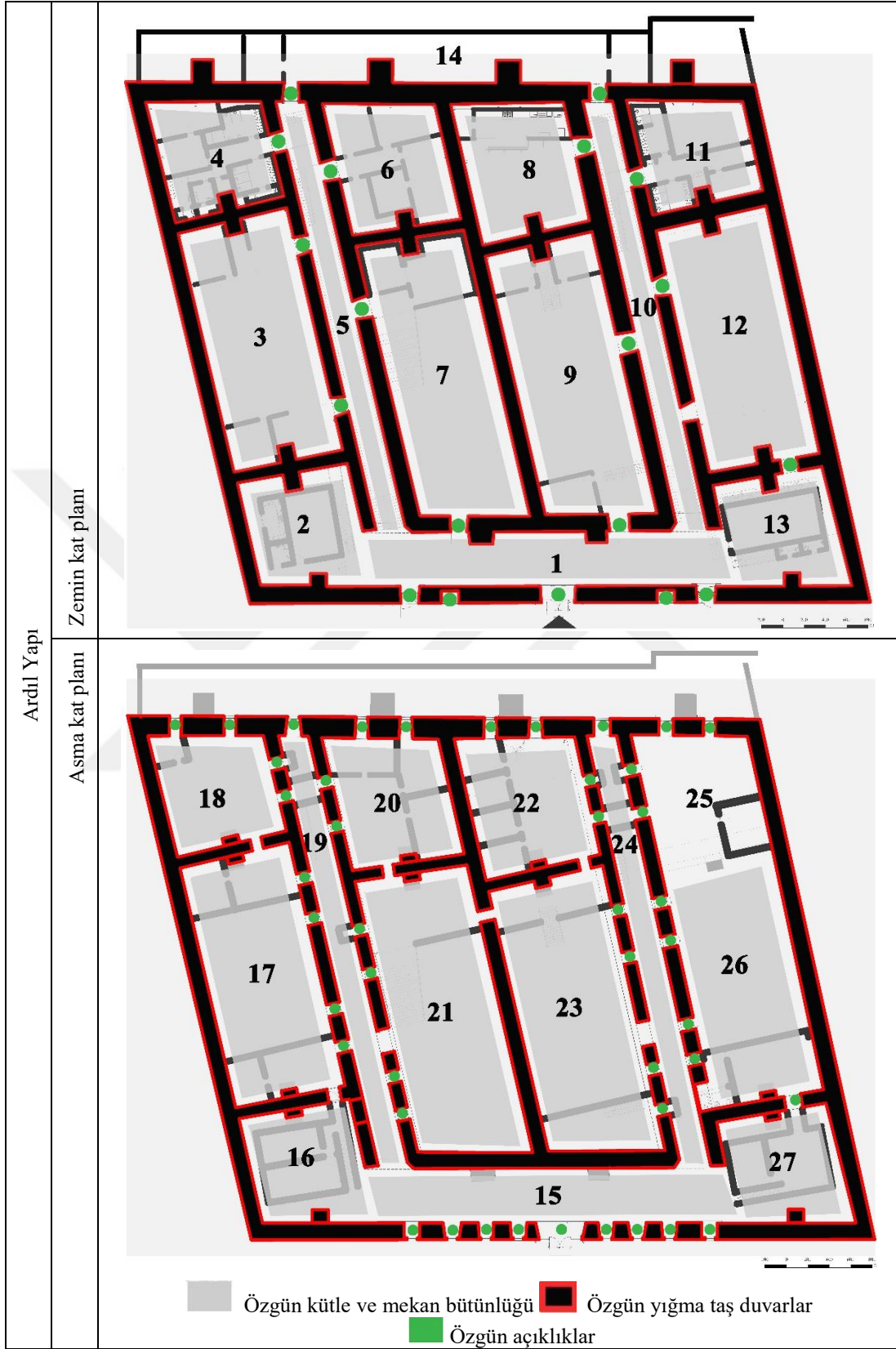
Şekil 39. Korunan kütle ve mekan bütünlüğü/sınırı ile korunan taş duvarlar ve açıklıklar
