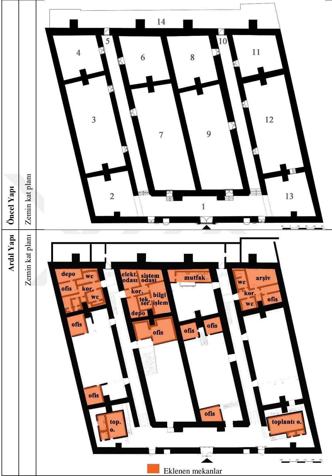
Şekil 44. Ardıl yapı zemin katta yeni mekanlar
