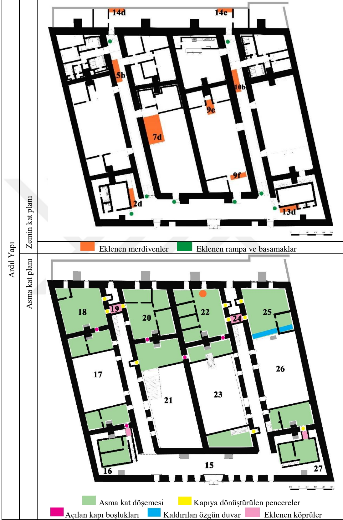
Şekil 28. Yapıya eklenen merdiven, köprü, rampa ve basamaklar ile değiştirilen yapı elemanları
