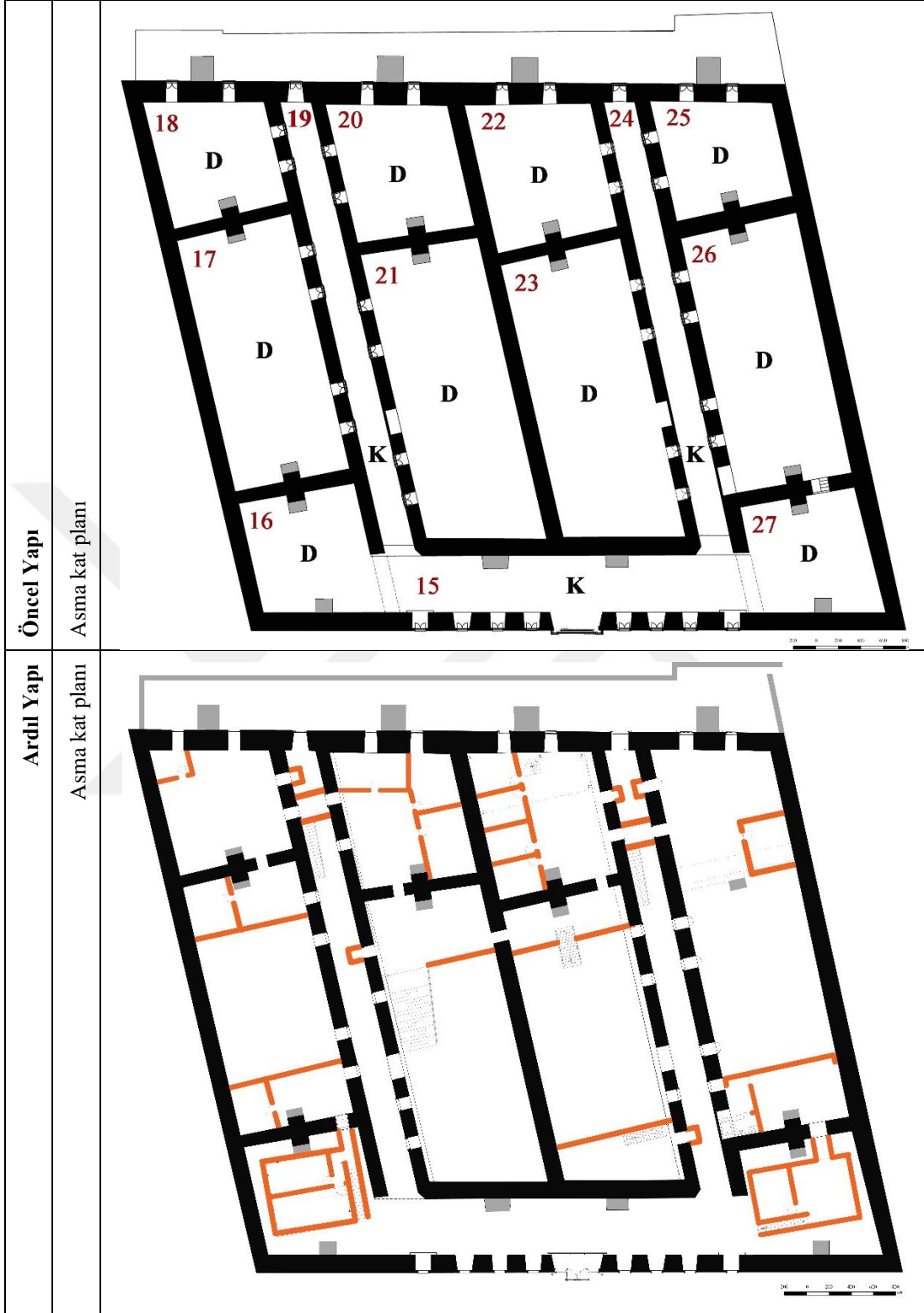
Şekil 26. Asma katta eklenen bölücü duvarlar
