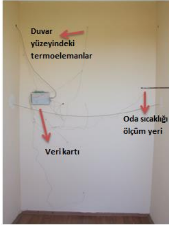
Şekil 31. Saydam ve opak yalıtımlı havalandırmasız (1-2-5 nolu) odaların güney duvar iç yüzeyi sıcaklık ölçüm yerleri
