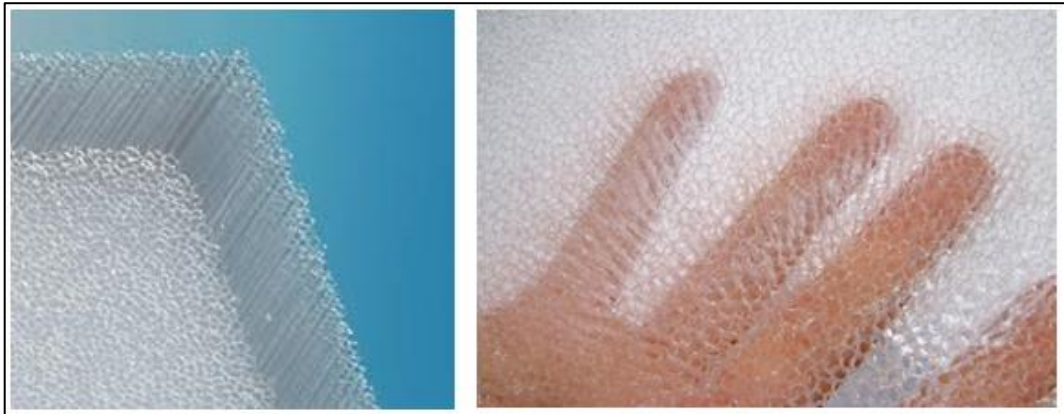
Şekil 25. Deney düzeneğinde kullanılan saydam yalıtım malzemesi (Kapipane)
