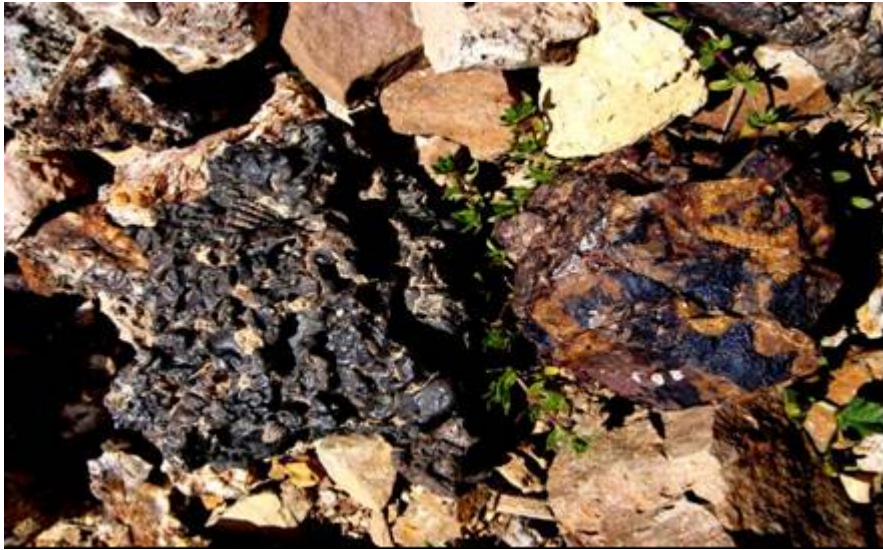
Şekil 10. Maden cevheri ve cevherler işlendikten sonra ortaya çıkan artıklara (cüruf: sol altta siyah görüntü) ait örnekler
