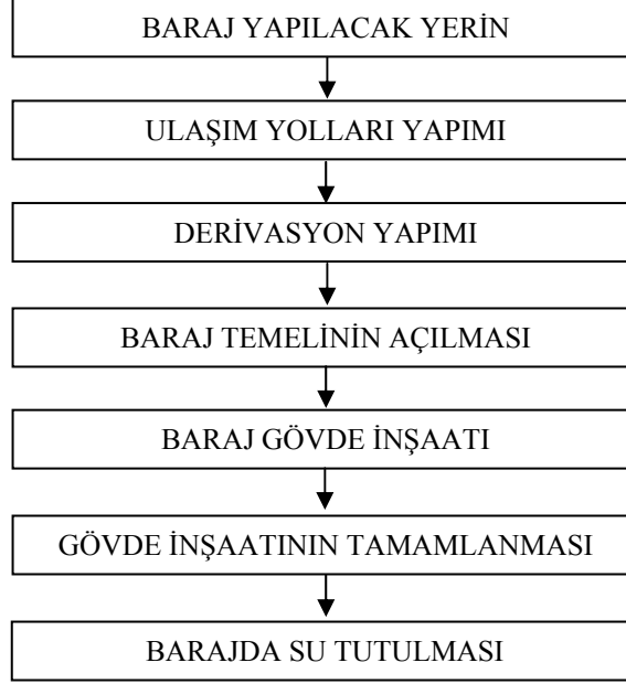
Şekil 16. Baraj inşaat süreci işleyiş şeması
