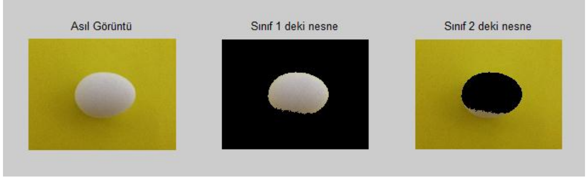
Şekil 44. RGB renk uzayından L^*a^*b^* renk uzayına dönüşüm yapılmadan K-means kümeleme ile temiz yumurtanın zeminden ayrılması
