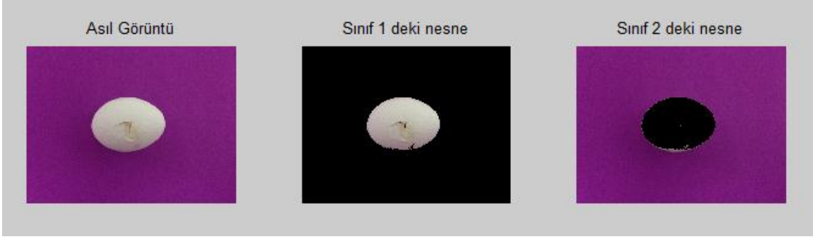
Şekil 42. RGB renk uzayından L^*a^*b^* renk uzayına dönüşüm yapılmadan K-means kümeleme ile kırık yumurtanın zeminden ayrılması
