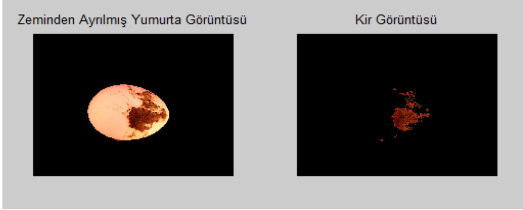
Şekil 53. Zeminden ayrılmış yumurta görüntüsü (solda) ve bölütlenmiş kir görüntüsü(sağda)
