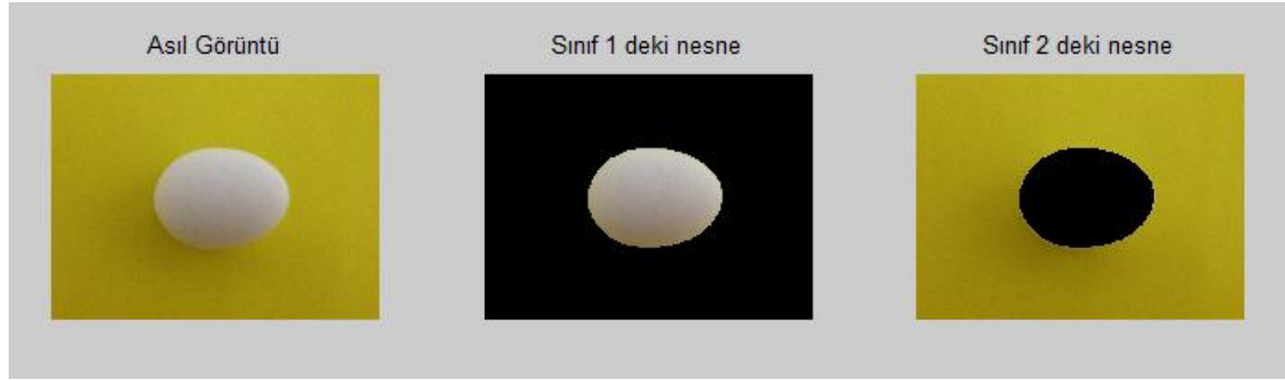
Şekil 45. RGB renk uzayından L^*a^*b^* renk uzayına dönüşüm yapılarak K-means kümeleme ile temiz yumurtanın zeminden ayrılması
