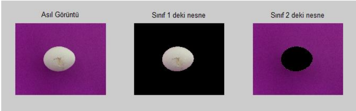
Şekil 43. RGB renk uzayından L^*a^*b^* renk uzayına dönüşüm yapılarak K-means kümeleme ile kırık yumurtanın zeminden ayrılması
