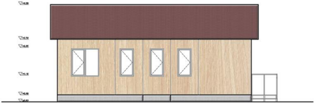
Şekil 62. 5-6 kişilik geçici afet konutu batı cephesi görünüşü
