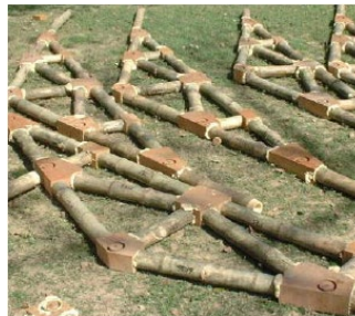
Şekil 85. Alman Bambu-Tech firması tarafından oluşturulan bağlantı (Yu, 2007).
