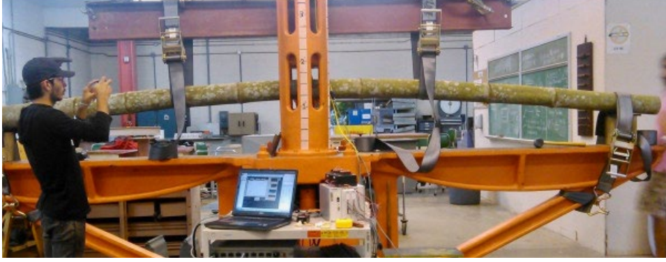
Şekil 25. Bambular için eğilme dayanımı testi (URL-31, 2020).
