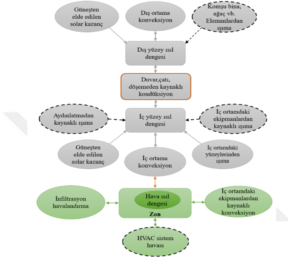
Şekil 16. ASHRAE ısı denge yöntemi akış şeması (bir bölgedeki ısı dengesi süreci) [57,58].
