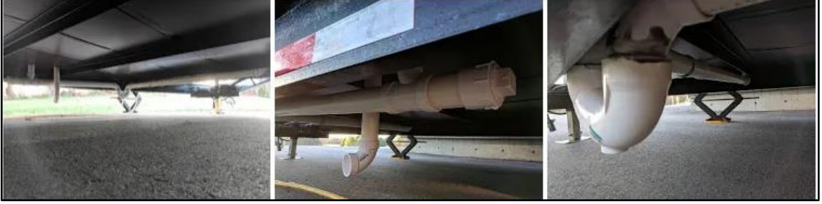
Şekil 98. Treyler altına yerleştirilmiş su boruları [118]
