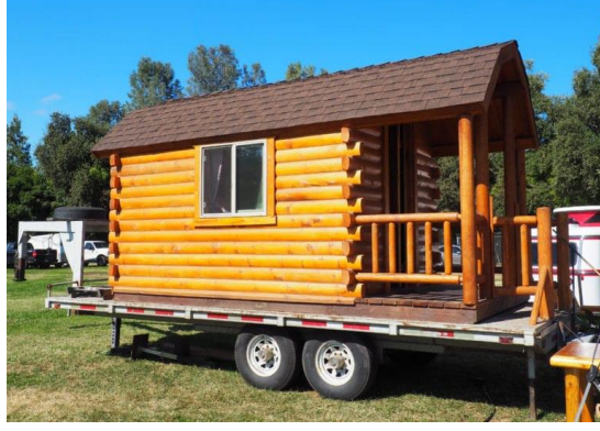
Şekil 65. Kızak üzerine inşa edilmiş ve römork ile taşınan bir mobil konut [81]
