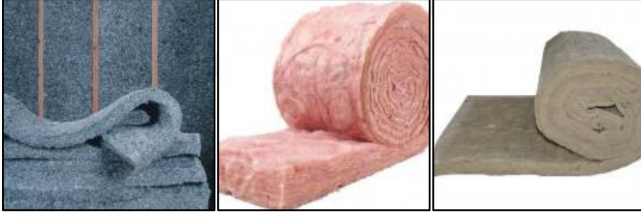
Şekil 82. Keçe yalıtım malzemeleri; denim/pamuk, fiberglas, taş yünü(soldan sağa)
