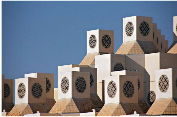
Şekil 1.26. Katar Üniversitesi'nde uygulanan rüzgar kuleleri [82].
