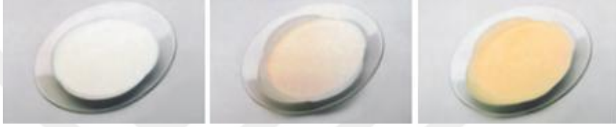
Şekil 12. Fotokromik pigmentlerin uyarıcı ışık ile renk değiştirmesinin aşamaları.
