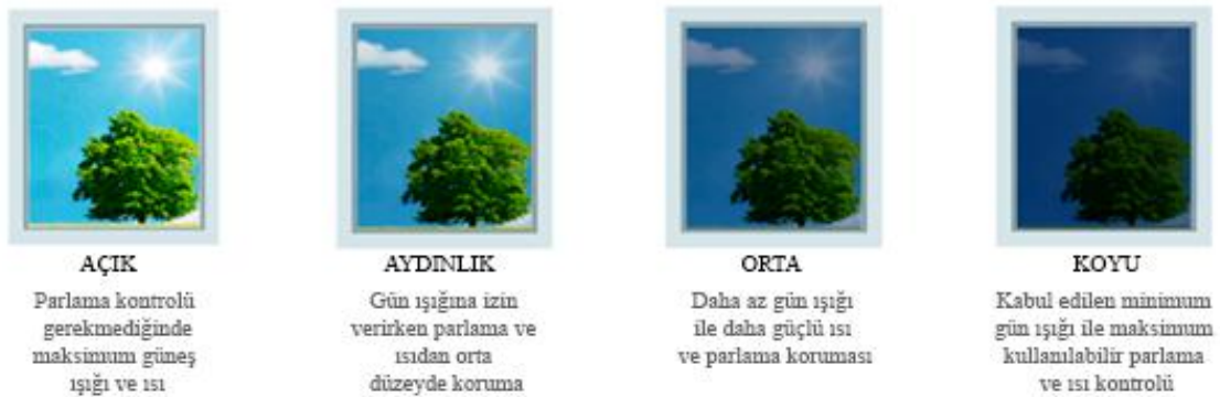
Şekil 7. Elektrokromik camların 4 aşamalı renk durumu (URL-5, 2020).
