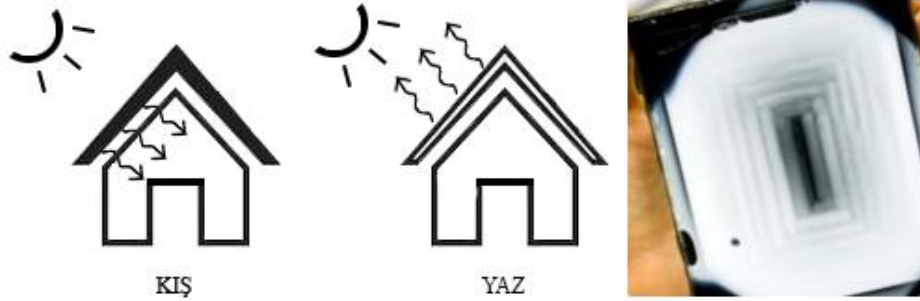
Şekil 22. MIT mezunları tarafından patentlenen termokromik çatı kiremiti Thermeleon ve çalışma prensibi (URL-27 ve 28, 2020).
