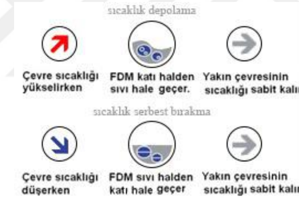
Şekil 41. Faz değiştiren malzemeler çalışma prensibi (Sarı A. , 2011).
