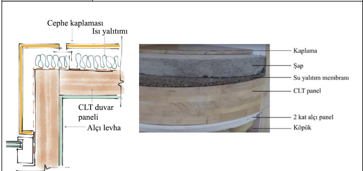
Detay çizim/Fotoğraf: Döşeme-Duvar detayları
