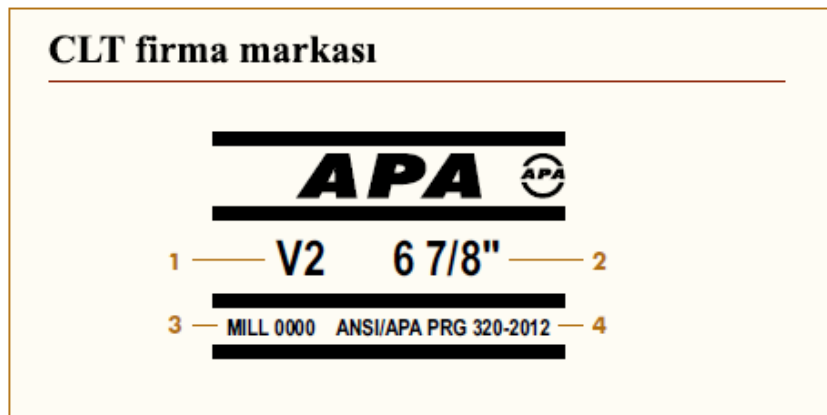
Şekil 2.24. CLT panel üzerine yapıştırılan etiket örneği (APA S500, 2016)
