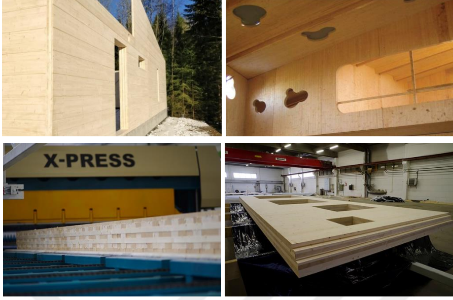
Şekil 2.22. CNC ile kesilmiş CLT panel (URL-76, 2019 ve Bejder, 2012)
