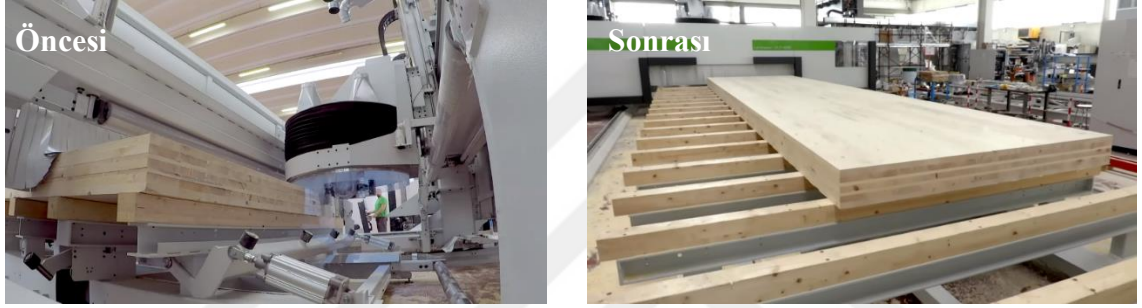
Şekil 2.20. CLT panel kenarında ve yüzeyinde planyalama işlemi uygulaması (URL-68, 2019)
