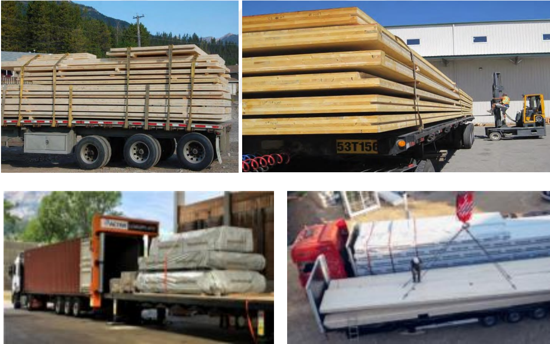
Şekil 2.30. CLT panel ile yüklenmiş nakliye araçları (Structurlam ve Binderholz, 2019)
