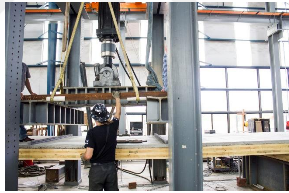
Beton kompozit döşeme sistemi-2
