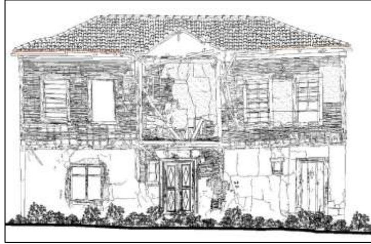
Şekil 35. Bekir Turan Evi'nin yıkık durumunun krokisi (Ataman, 2020).
