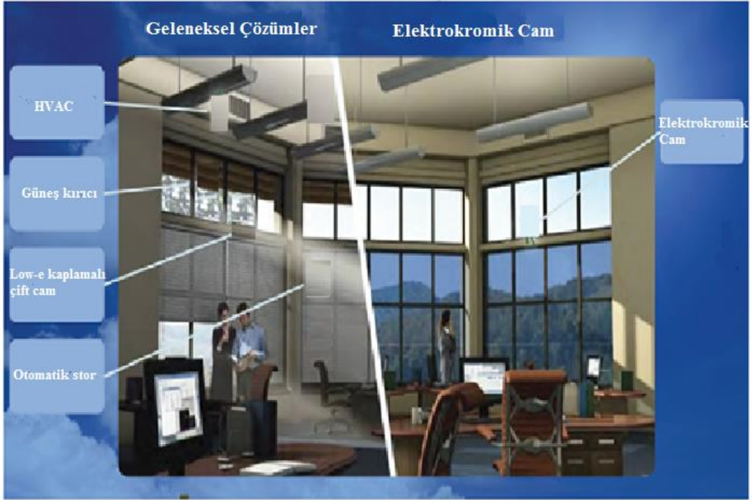
Şekil 2.7. Elektrokromik camlar ve geleneksel cam çözümleri (URL-10, 2018).
