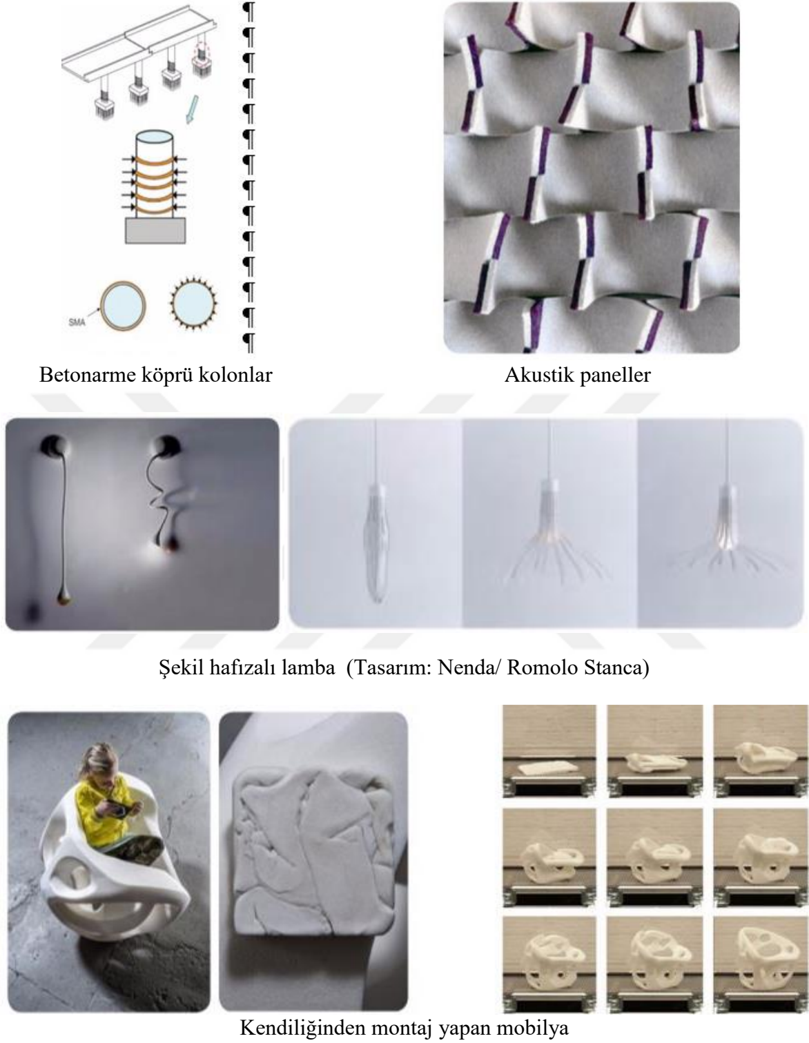
Şekil 2.71. Şekil hafızalı alaşım uygulama örnekleri (URL-82, 2017).
