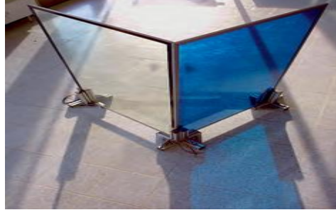
Şekil 2.5. Tungsten kaplamalı 2 adet cam sol cam renksiz sağ cam Prusya mavisi (Kazanasmaz ve Diler, 2011).
