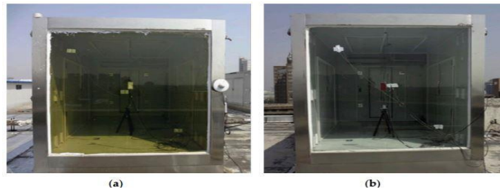
Şekil 2.17. Termokromik ( VO^2 ) cam örneği (a), basit cam örneği (b) (Anderson vd., 2016).
