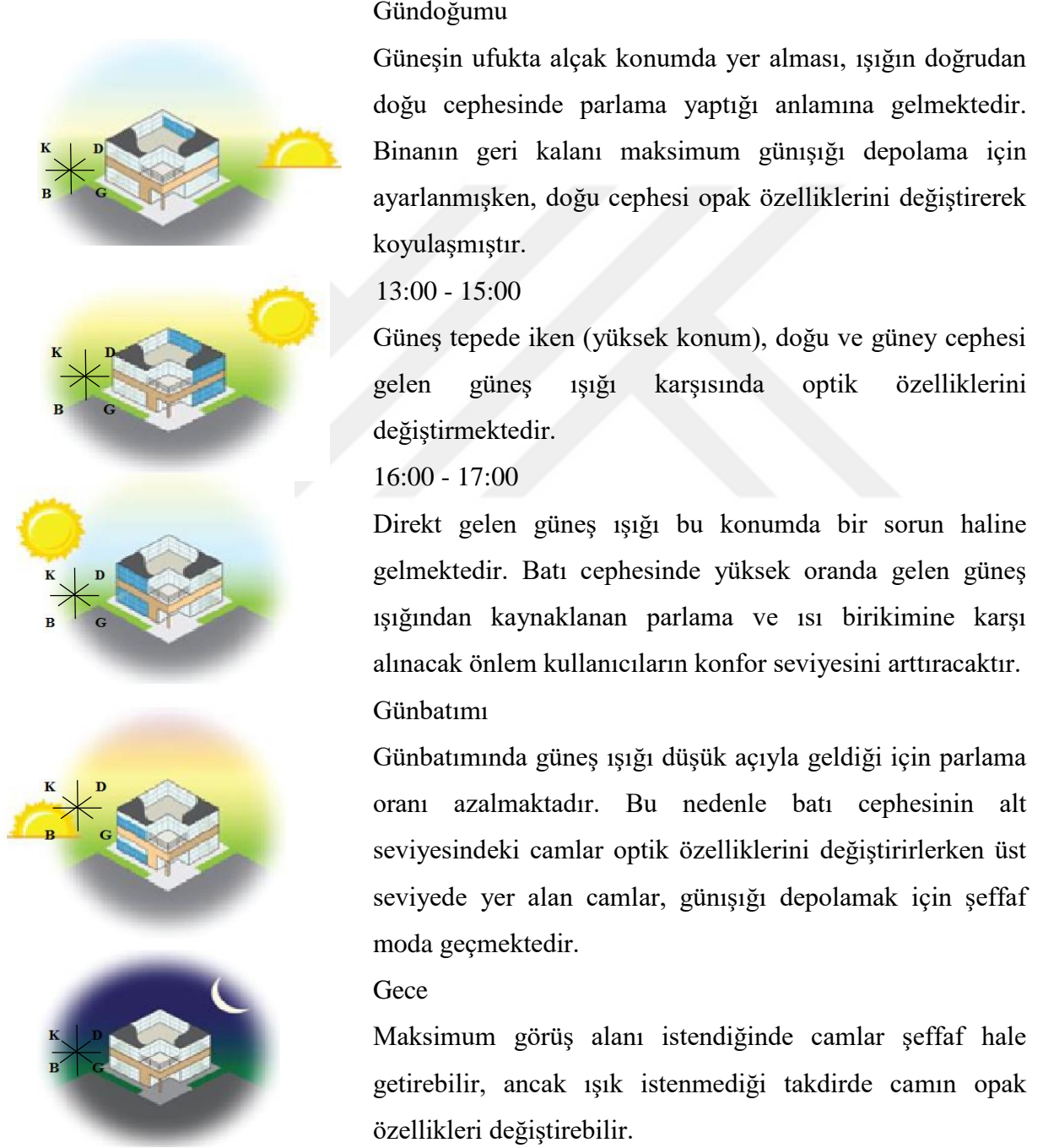
Şekil 2.9. Elektrokromik camın gün içinde güneş konumuna göre davranışı (URL-8, 2017).
