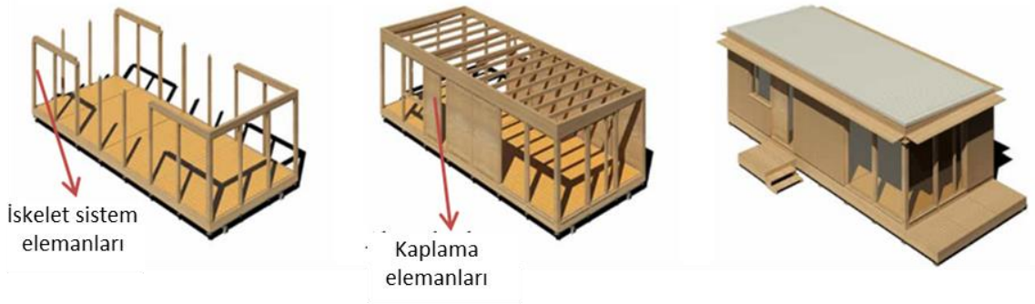
Şekil 102. İskelet sistemli prefabrike ahşap hücre (URL-102, 2018)
