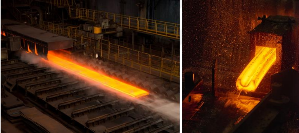
Şekil 46. Sıcak haddelenmiş çelik üretim aşaması (URL-24, 2018)
