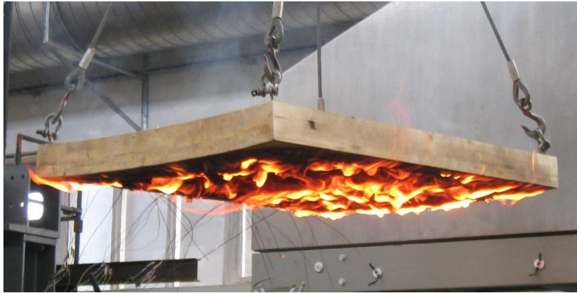
Şekil 2.20. CLT Panel test yangını ve kömürleşme koruması [47]
