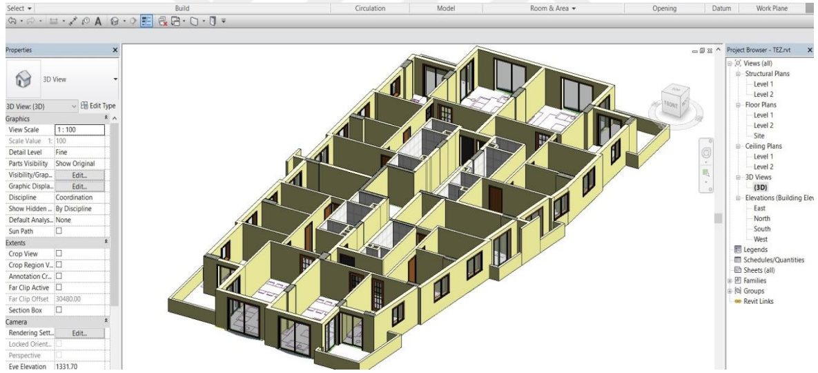
Şekil 43. Duvarlar, kapılar ve pencerelerin yerleştirilmesi ve 3D olarak kontrolü
