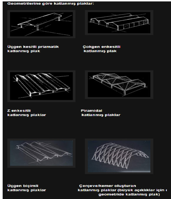
Şekil 1. 8. Geometrilerine göre katlanmış plaklar [44].
