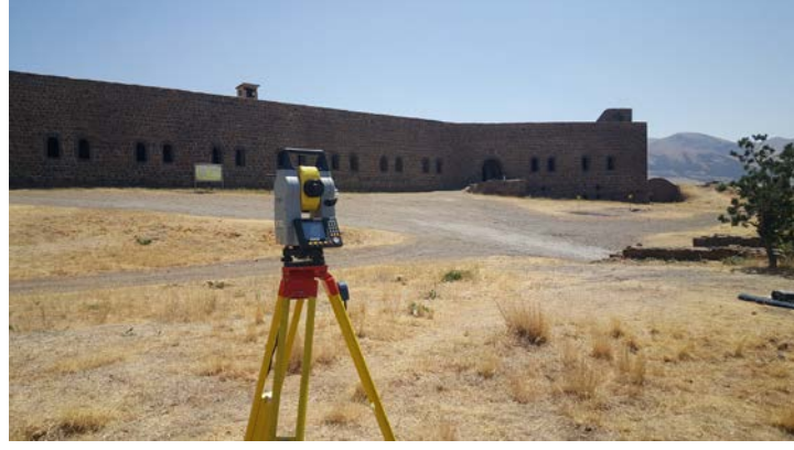
Şekil 86. Total station ve ölçü alma
