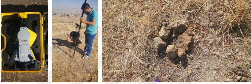
Şekil 85. Total station ve CORS yardımı ile noktaların belirlenmesi
